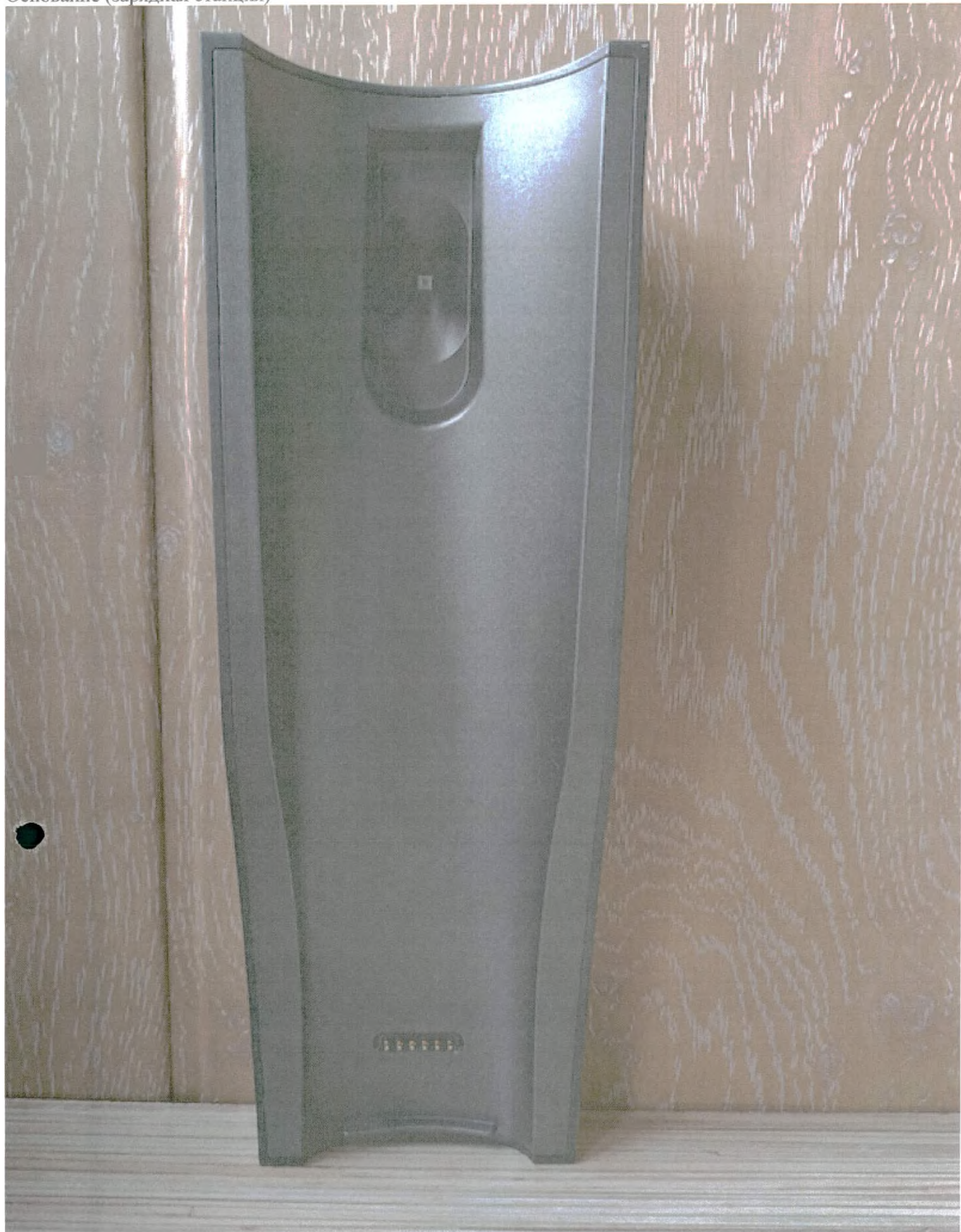
Основание (зарядная станция)
