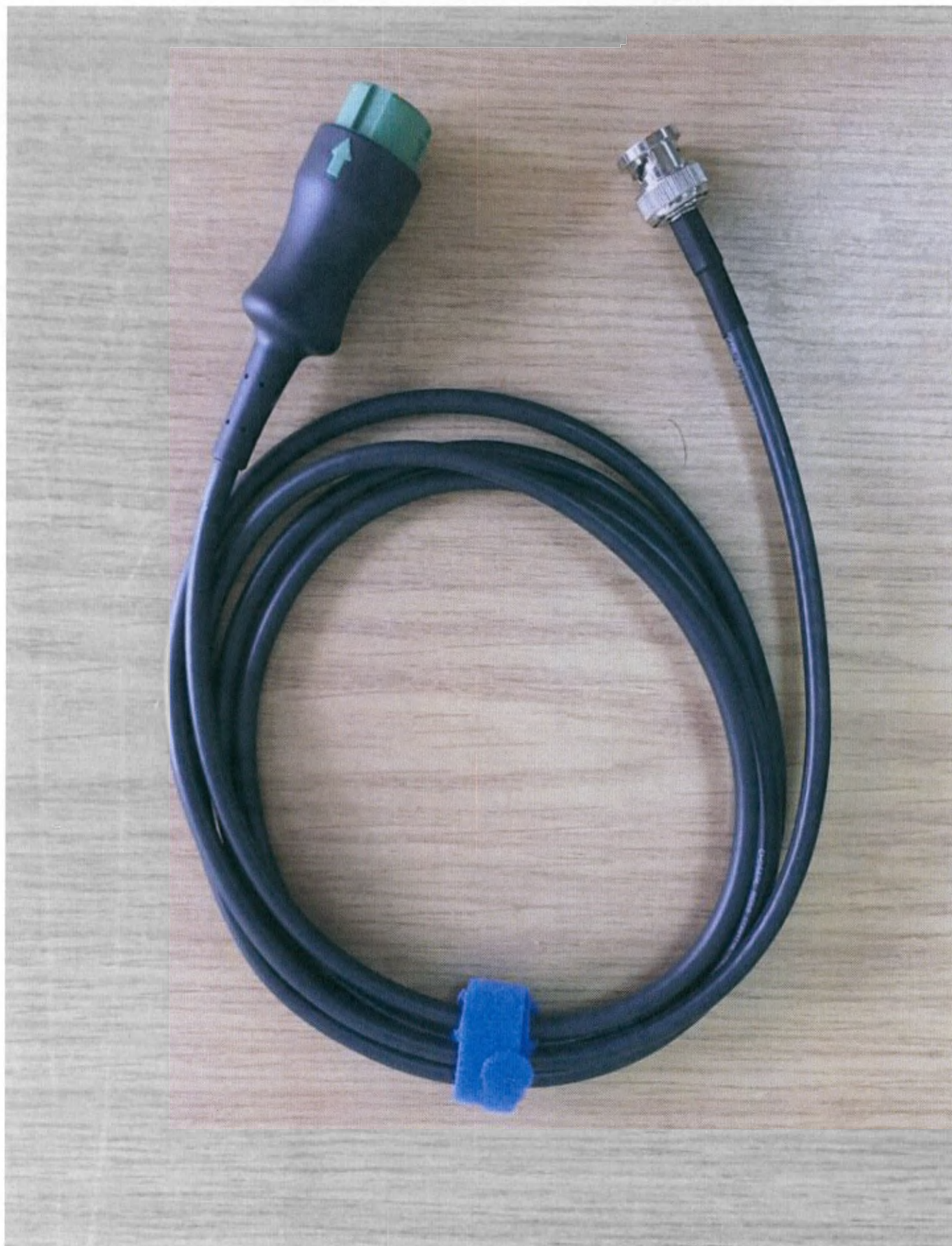
Кабель DC-IN для модуля ЭКГ, марка TAIJIA
