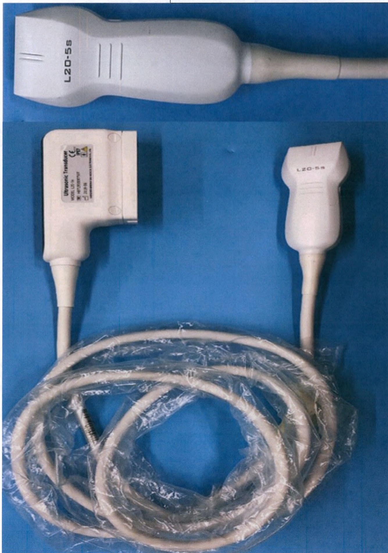
Датчик ультразвуковой линейный L20-5s
