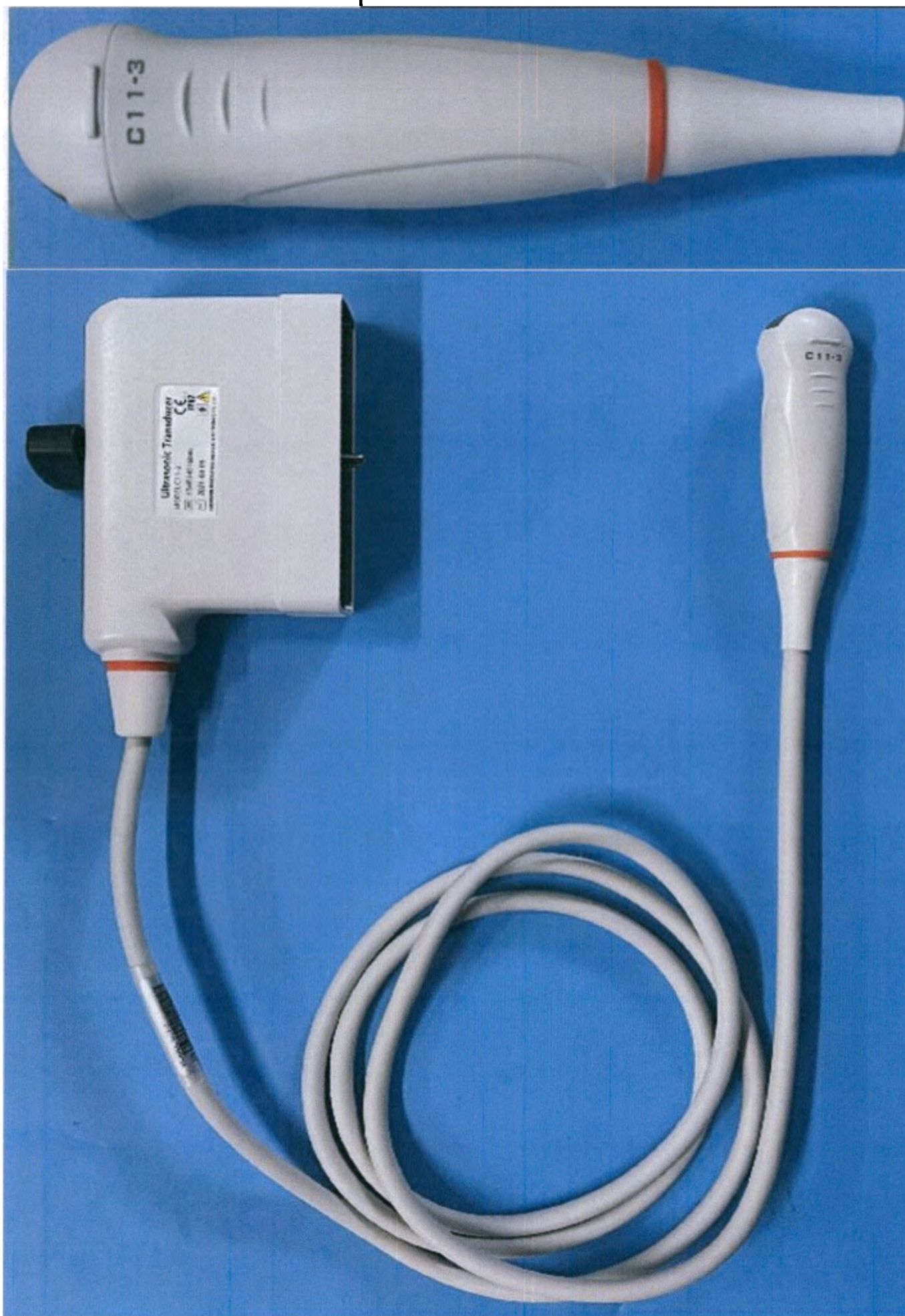
Датчик ультразвуковой микроконвексный С11-3
