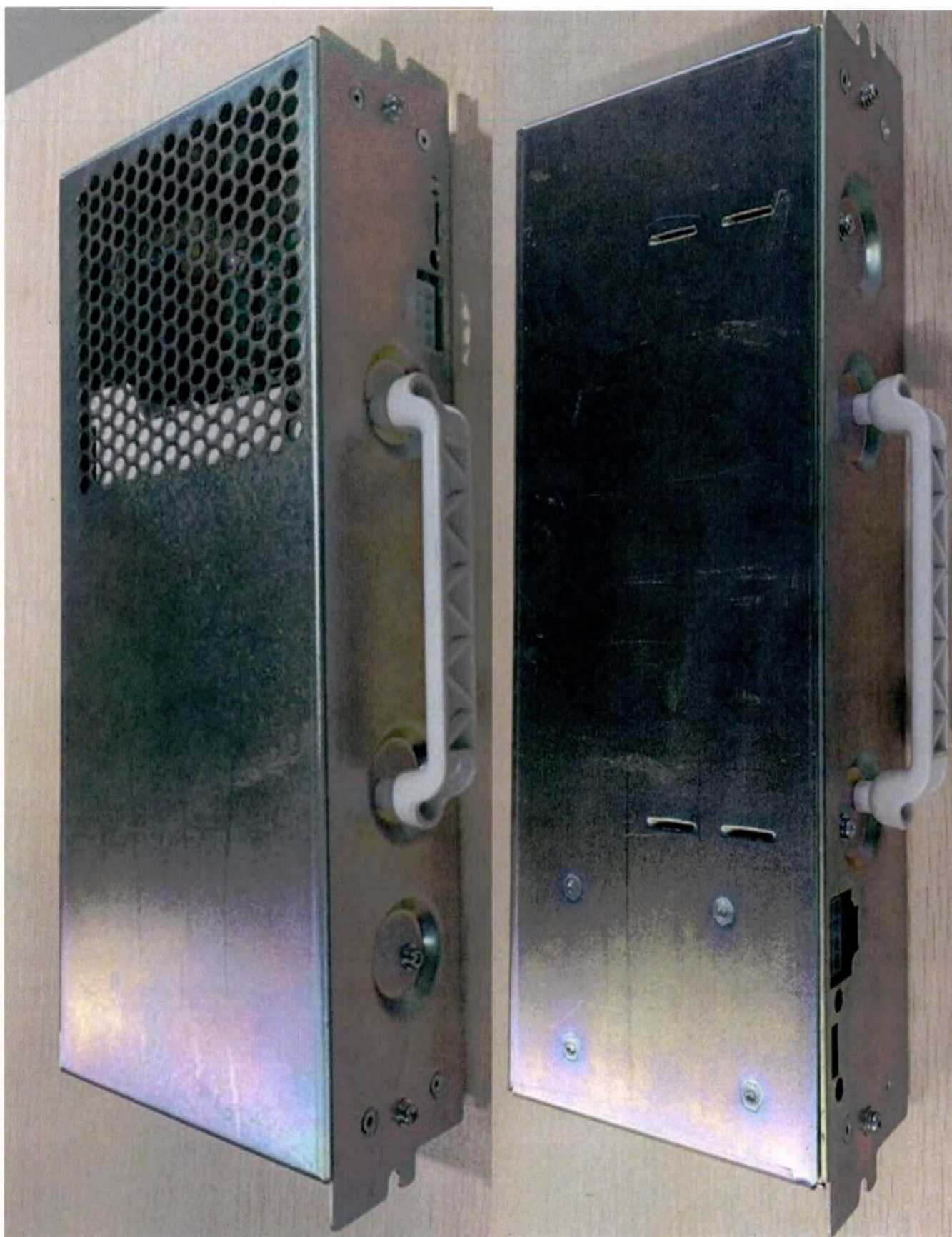
Аккумулятор, модель LI24I001H - Виды 1, 2
