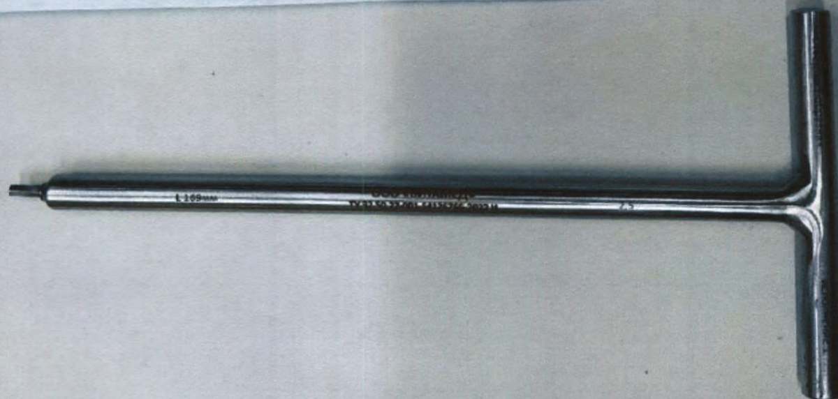
Отвёртка Т-образная, исполнение 1: длиной от 150 мм до 180 мм с шагом 1 мм под шлиц размером 2,5мм;3,5мм
