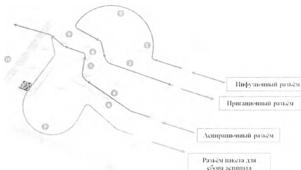
Рисунок 9. Функциональные части кассеты для работы от перистальтической помпы и помпы Вентури.
