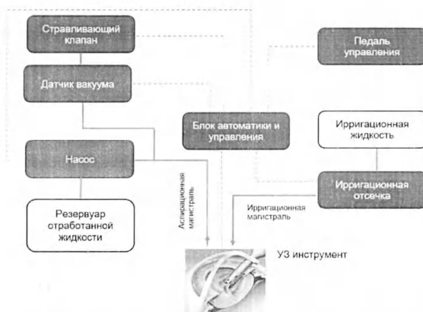
Рисунок 1. Принципиальная схема работы системы Sophi
