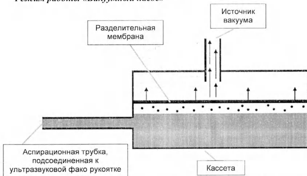
Рисунок 8. Схематическое изображение принципа работы «вакуумный насос».
