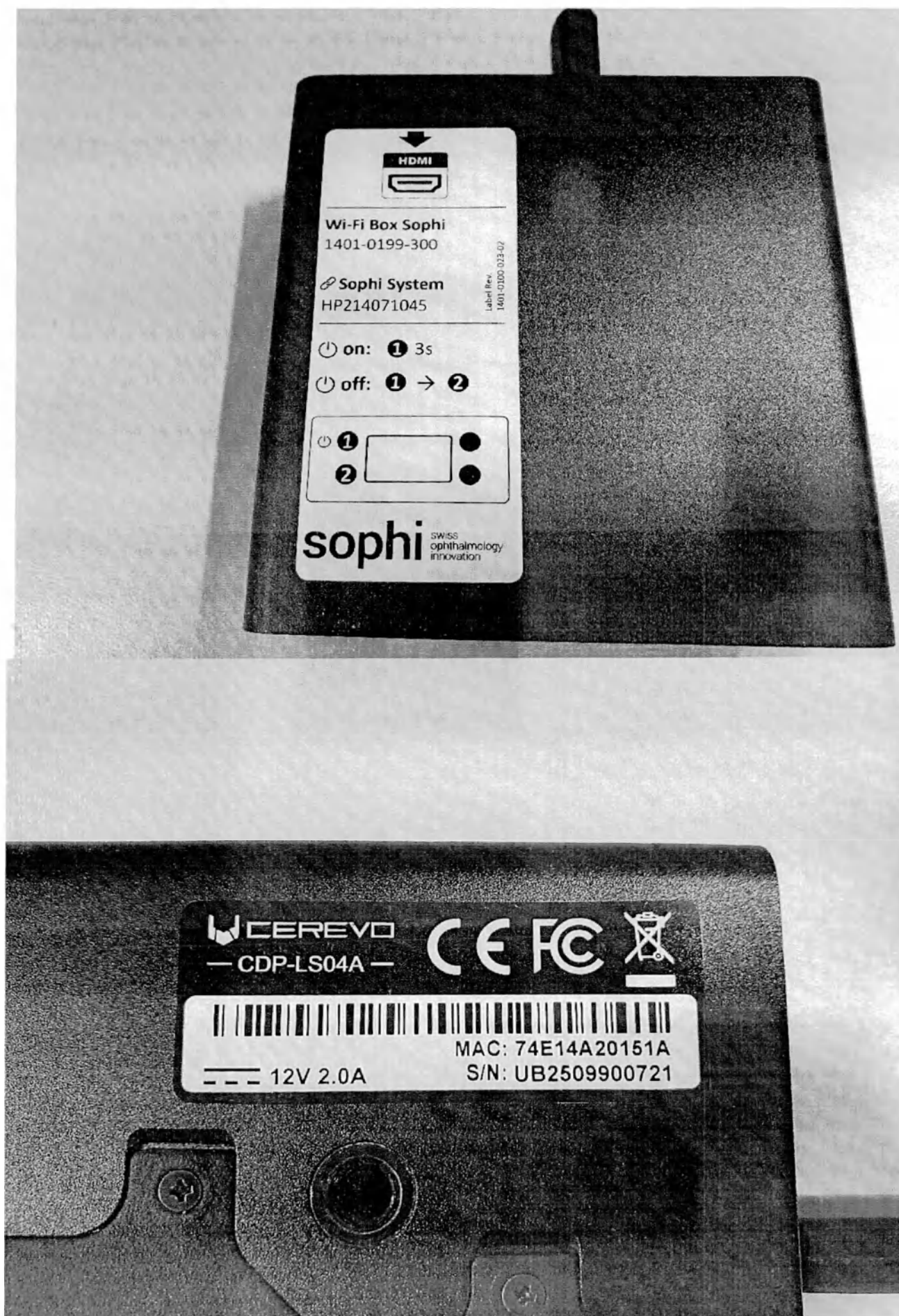
Рис 7 – Устройство для передачи видео по Wi-Fi. Маркировка
