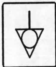
ЗАЖИМ ДЛЯ ЭКВИПОТЕНЦИАЛЬНОГО СОЕДИНЕНИЯ
