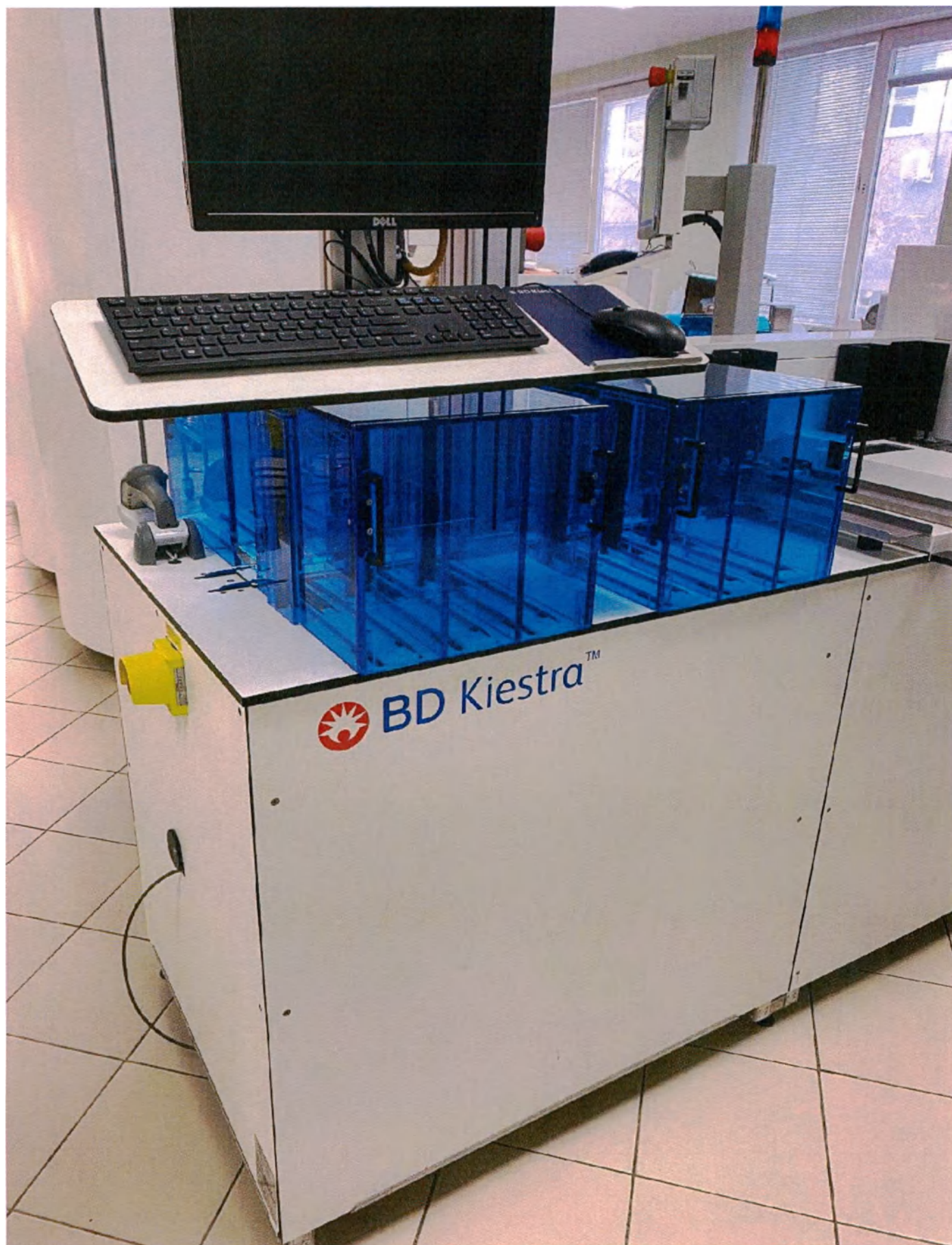
Модуль SorterA для сортировки чашек Петри
