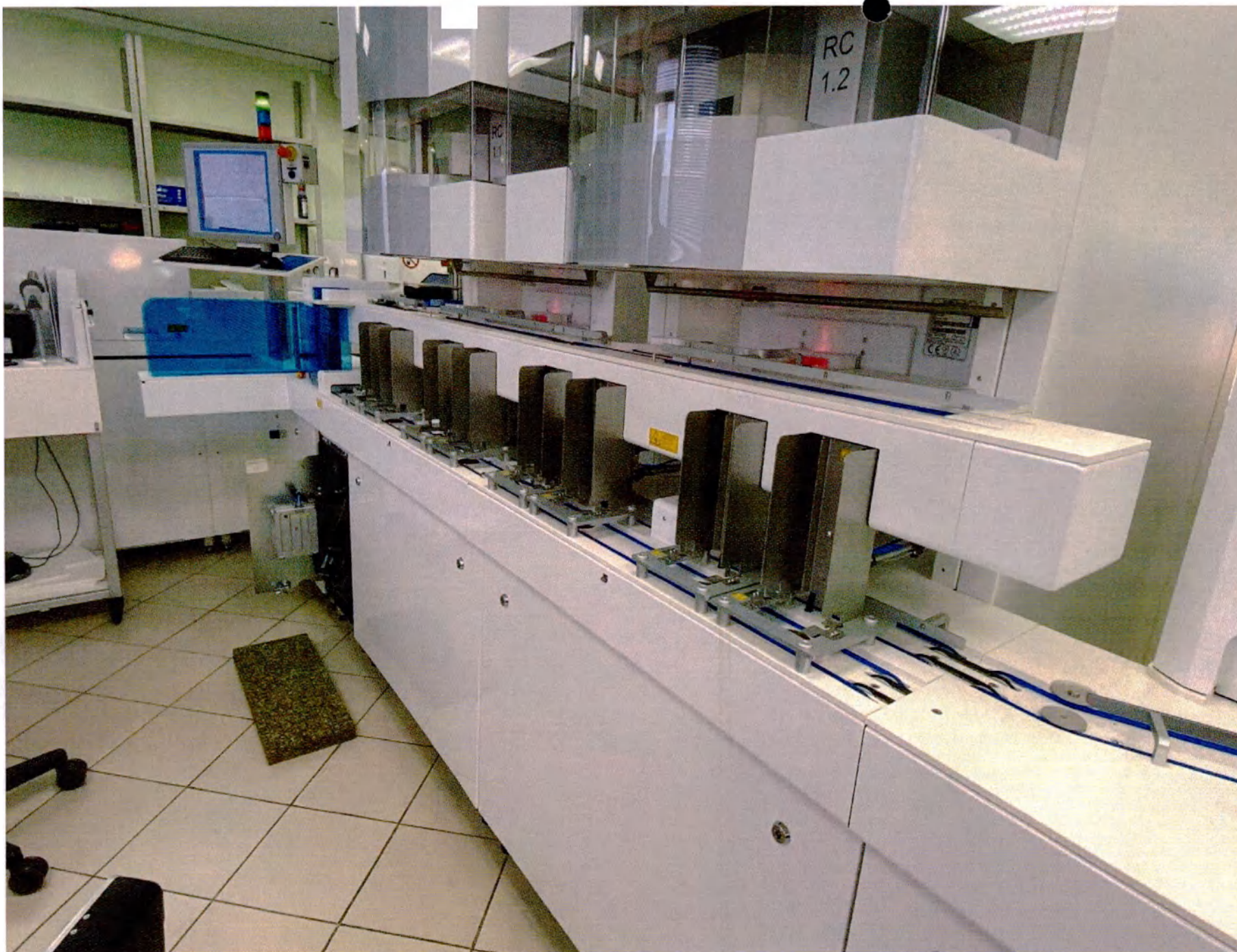
Модуль ProceedA WCA для транспортировки чашек Петри с двумя встроенными лазерными сканерами
