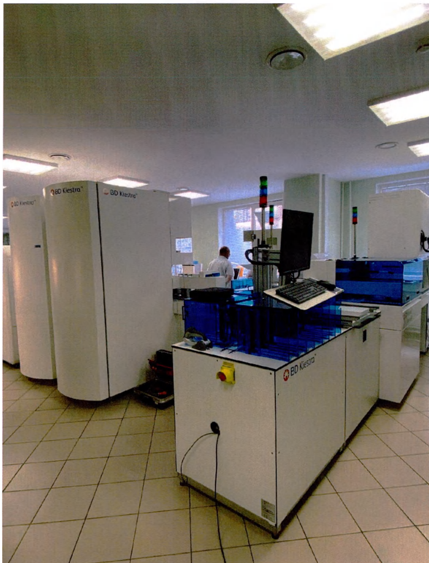
Автоматизированная модульная система BD Kiestra WCA для обработки образцов человека для исследований в микробиологии
