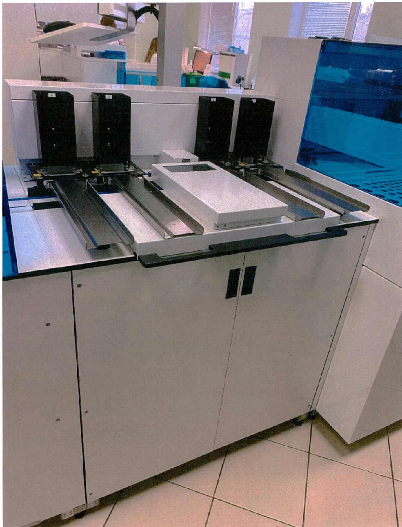
Модуль BarcodA для маркировки чашек Петри
