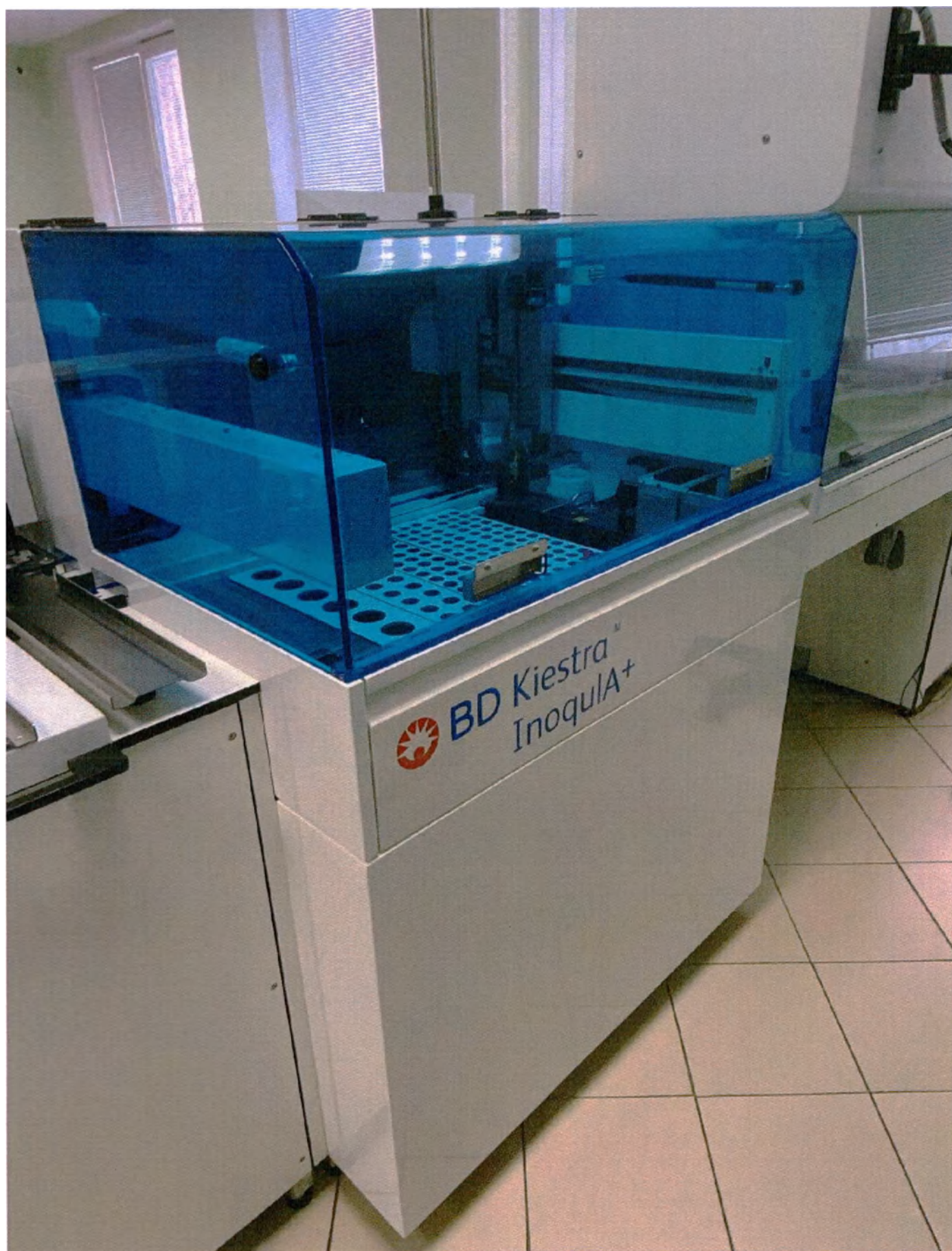
Модуль FA для обработки образцов в автоматическом режиме
