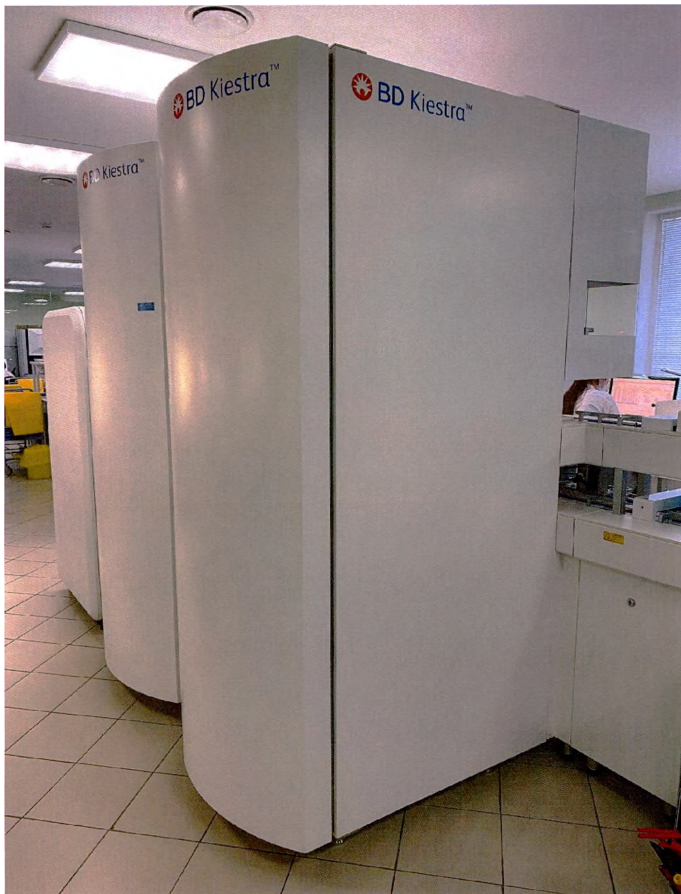
Модуль BD Kiestra ReadA Compact для инкубации и фотографирования чашек Петри
