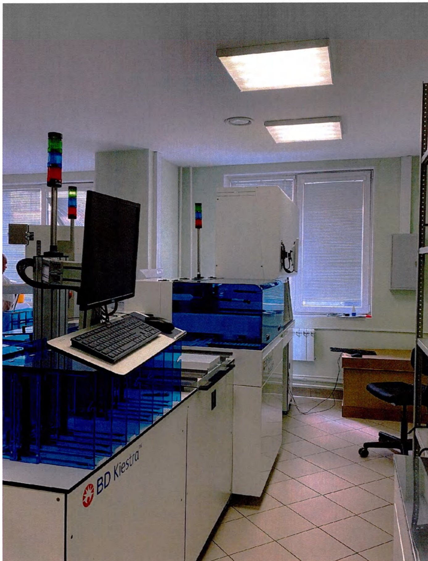
Автоматизированная бактериологическая рабочая станция BD Kiestra InoculA+ для обработки образцов
