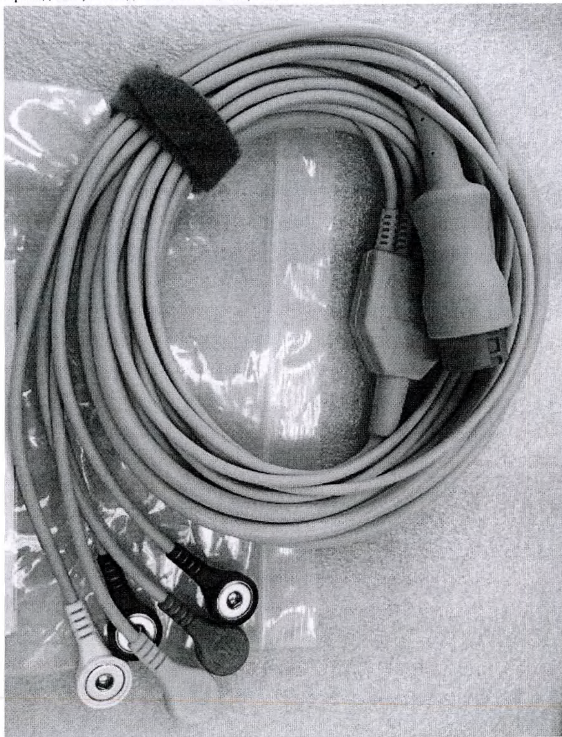
Провод ЭКГ, 5 отведений тип зашелка, модель EA6252B
