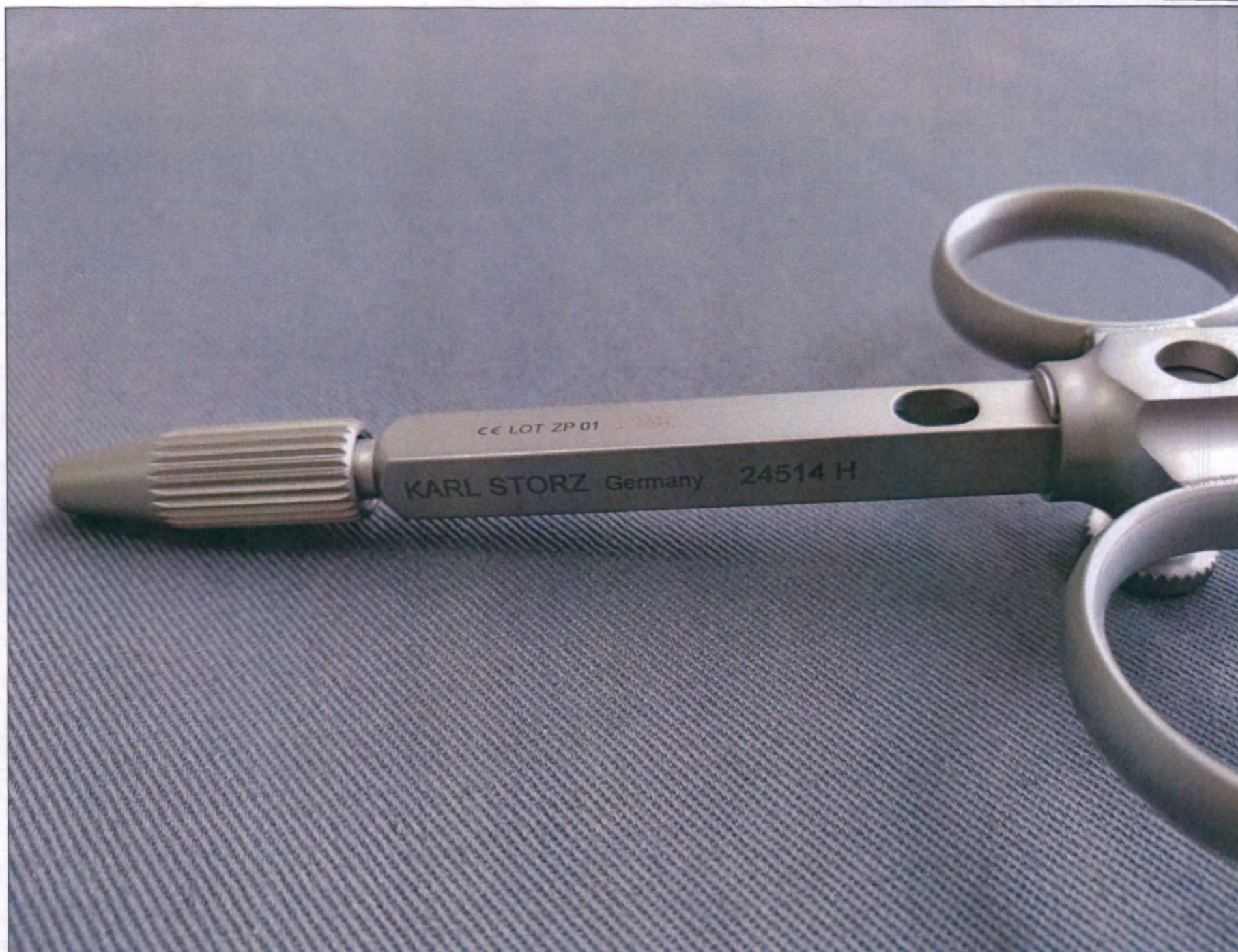
Рис. 46. Рукоятка трехкольцевая для щетки. Маркировка на изделии.
