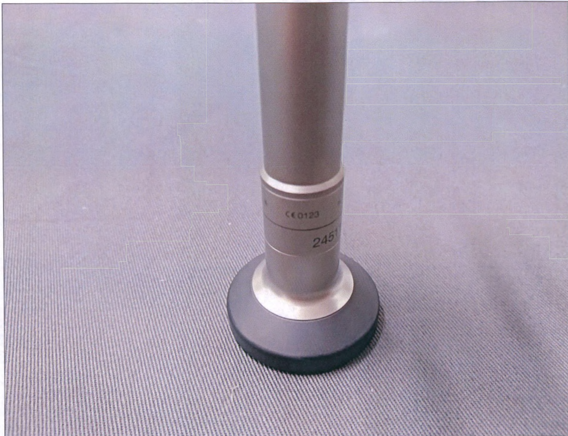
Рис. 18. Фистулоскоп жесткий, направление наблюдения 8°, диаметр 3,3/4,7 мм, длина 18 см. Маркировка на эндоскопе.
