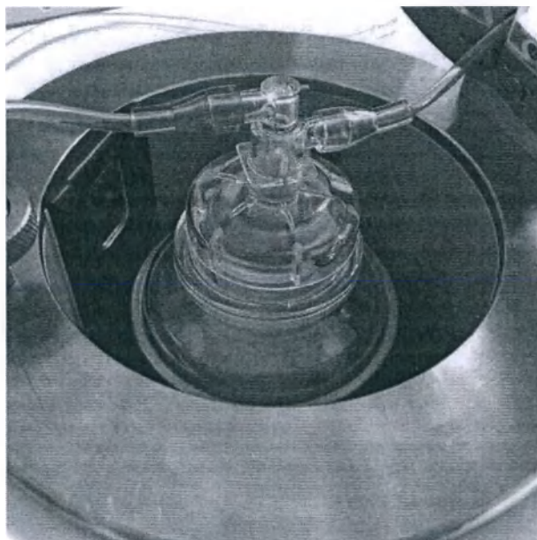
Рисунок 20 Установка колокола одноразового комплекта
