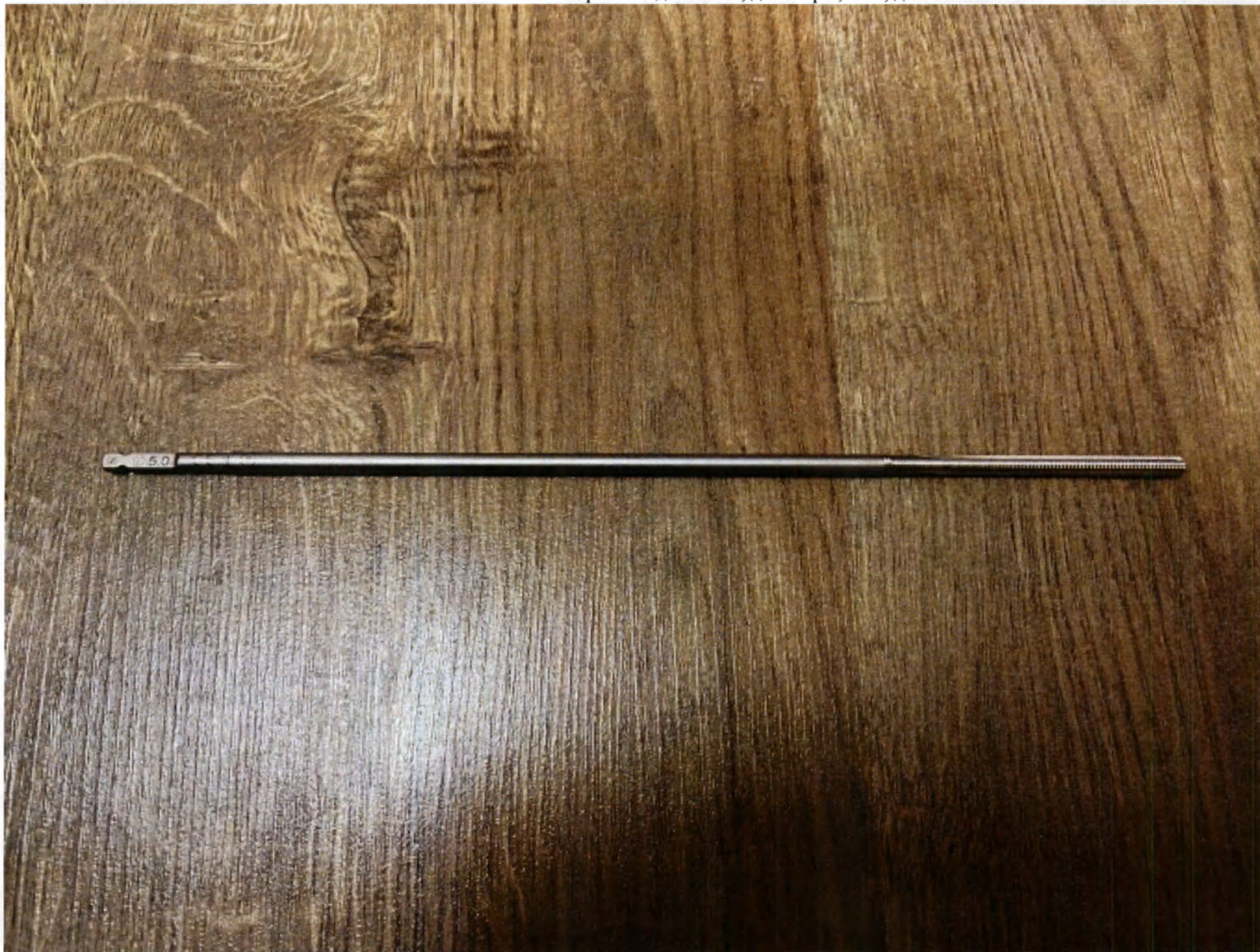
14. Метчик с быстрым соединением, диаметр 5,0 мм, длина 250 мм
