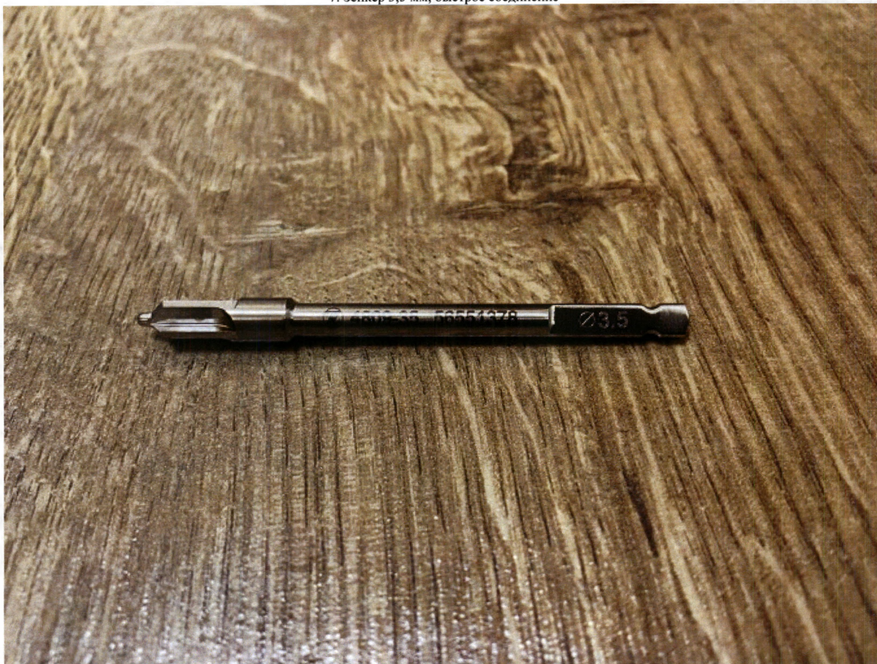
7. Зенкер 3,5 мм, быстрое соединение
