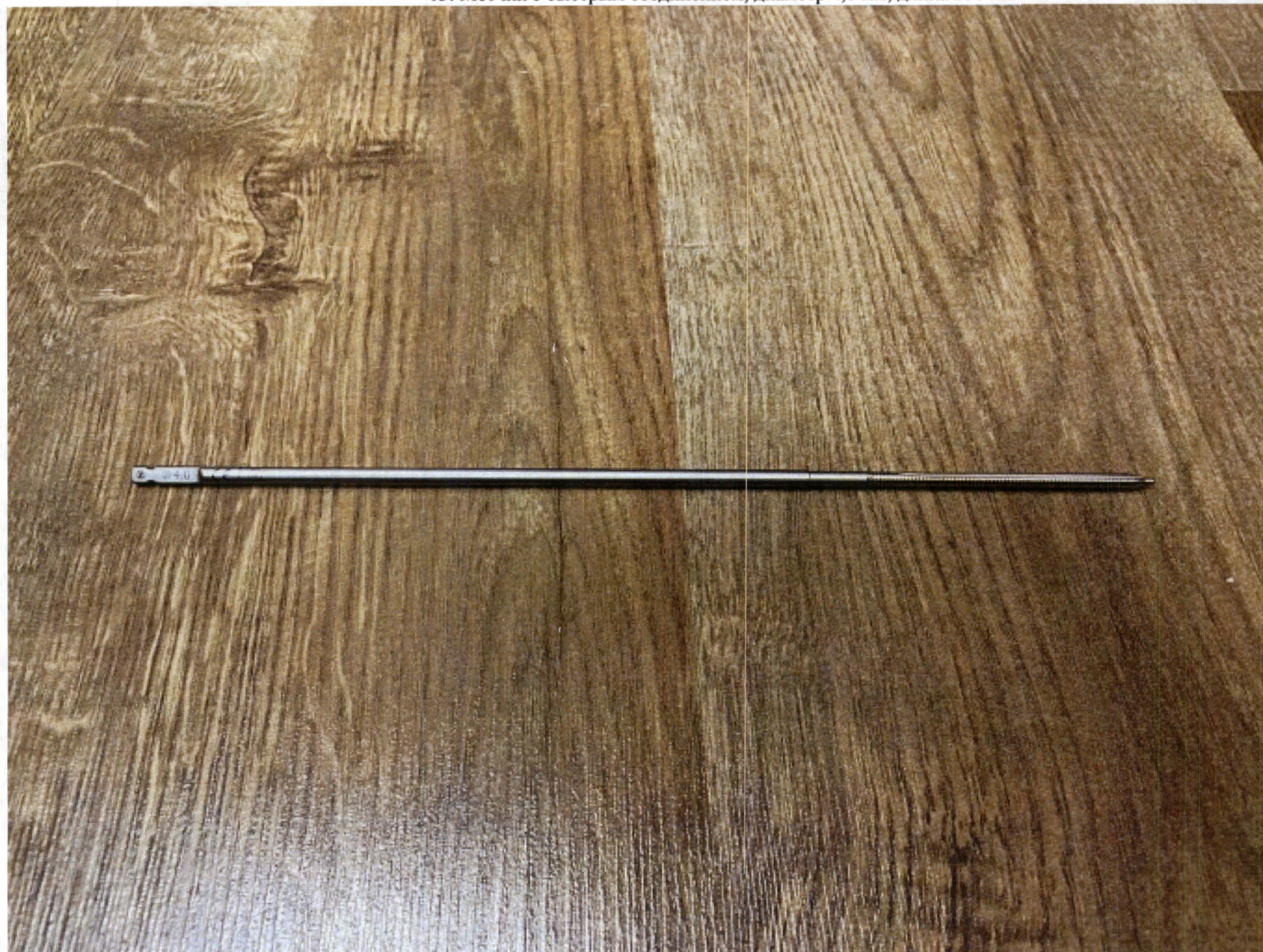
13. Метчик с быстрым соединением, диаметр 4,0 мм, длина 250 мм
