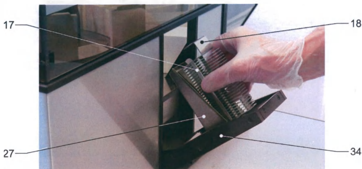
Рисунок 30. Установка штатива на парковочную станцию шлюза.
