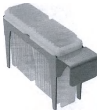
Рисунок 5. Штатив-вкладыш ШВВ-20 и штатив держатель ШД-20 в сборе
