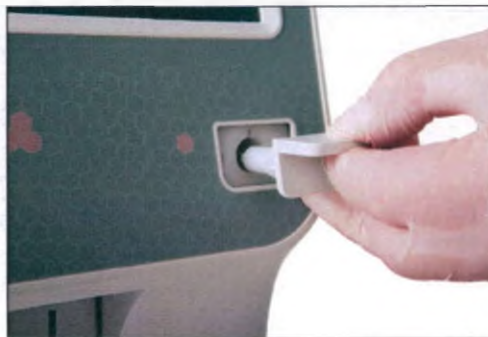
Рисунок 35. Установка МКА в анализатор
