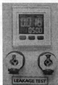
Штуцеры теста на герметичность (показатель давления и настройка теста)
