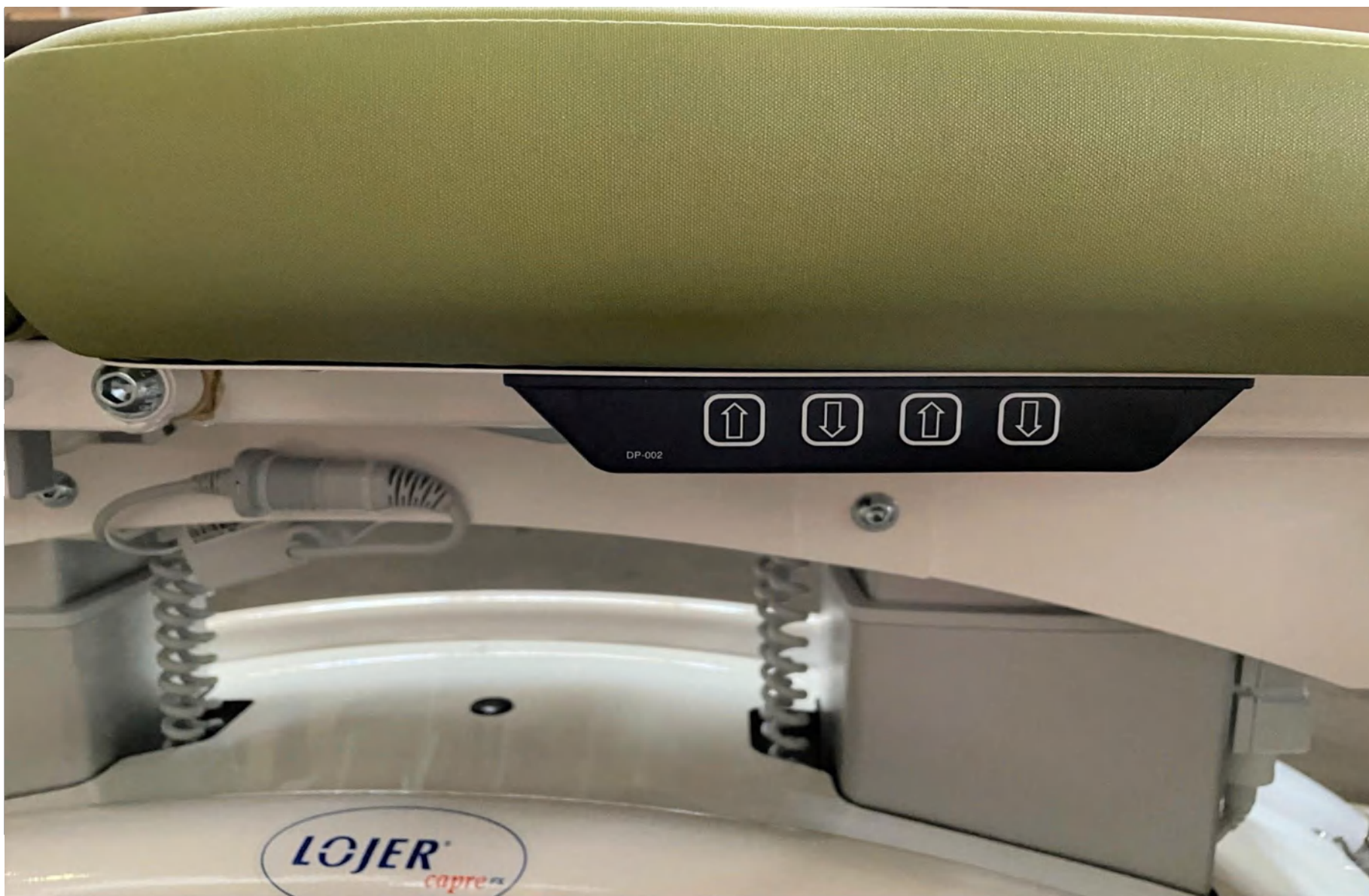
6.13 Электропривод регулировки дренажного угла средней и ножной секции
