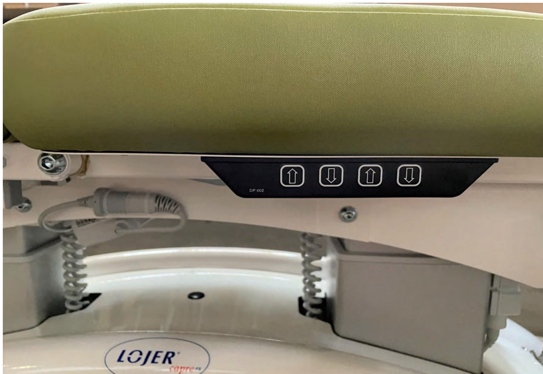
4.14 Электропривод регулировки дренажного угла средней и ножной секции
