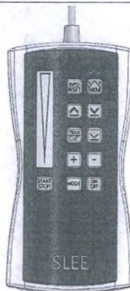
Внешняя панель управления CUT 6062
