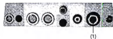
1 Порт для подключения ножного переключателя или ножной педали
