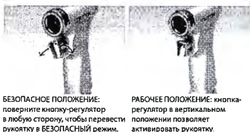
Рис. 2-7. Безопасное и рабочее положения рукоятки Triton
