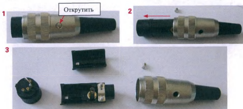
Рисунок 14 – Как открыть разъем блокировки
