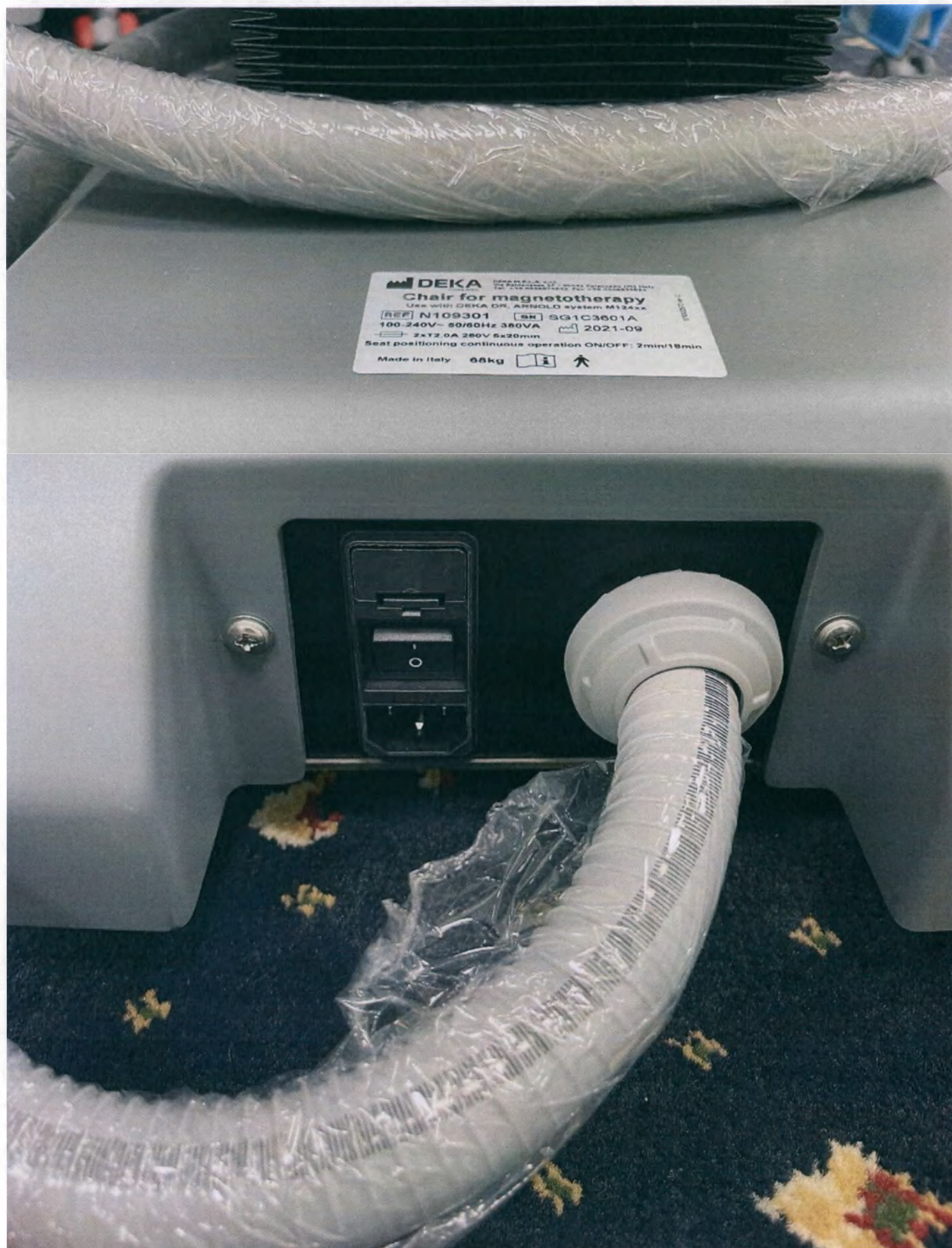
Фото 16 - Кресло-аппликатор для магнитотерапии Подключение сетевого кабеля кресла-аппликатора к основному блоку системы
