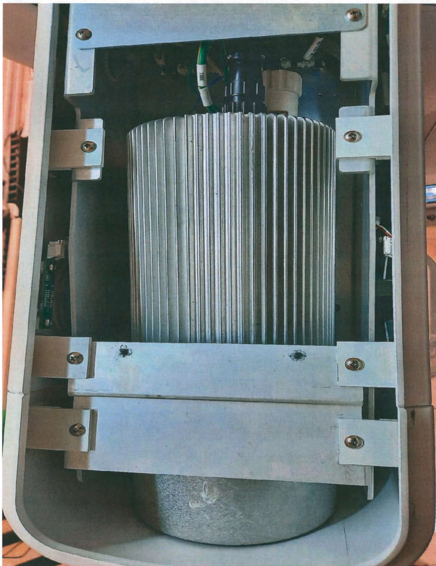
Рис 1.4. Рентгеновский излучатель, модель В-121 с рентгеновской трубкой, модель М-113Т, производства Varex Imaging Corporation, США;
