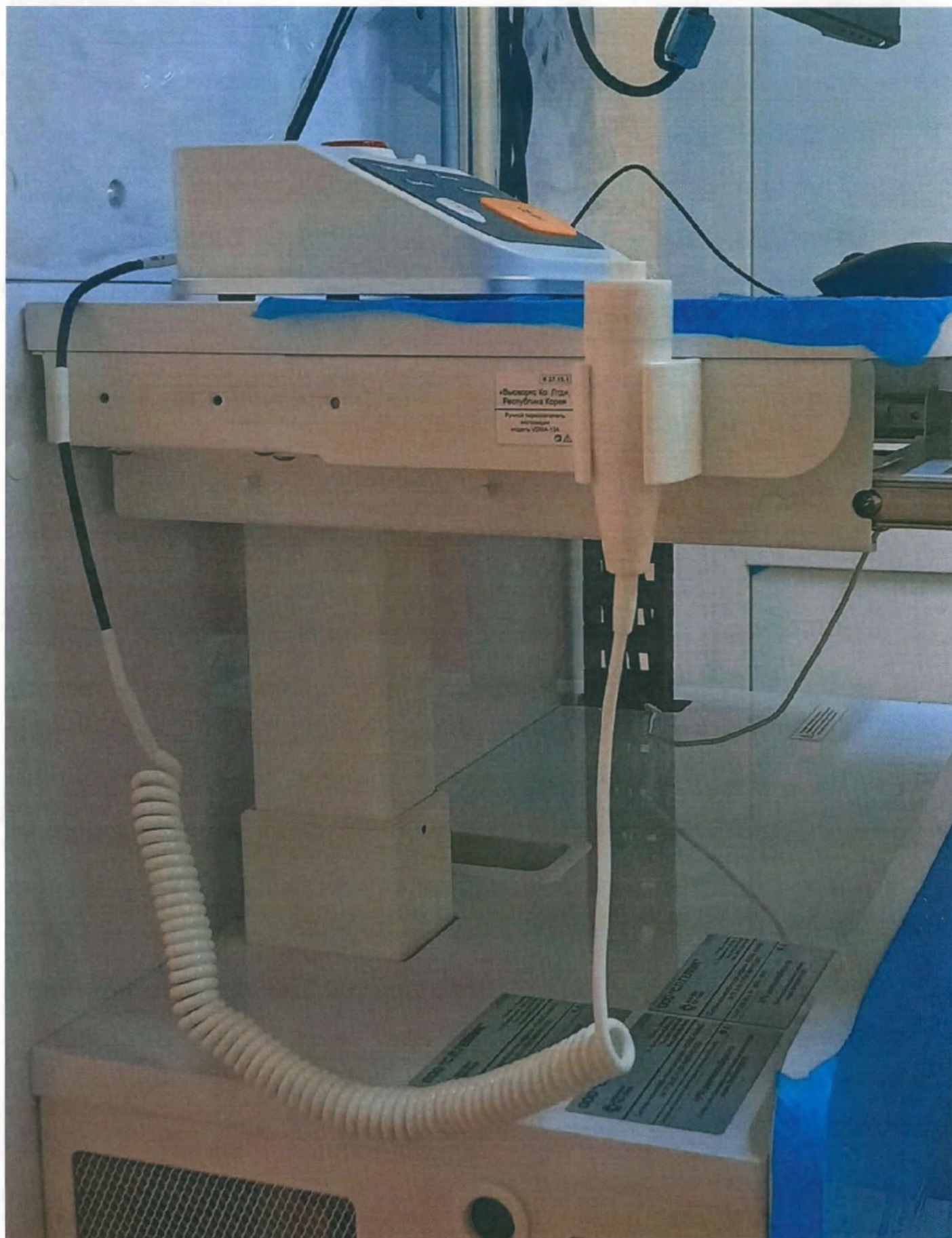
Рис 14. Ручной переключатель экспозиции, модель VDMA-12A / VDMA-13A, производства «Вьюворкс Ко. Лтд», Республика Корея;
