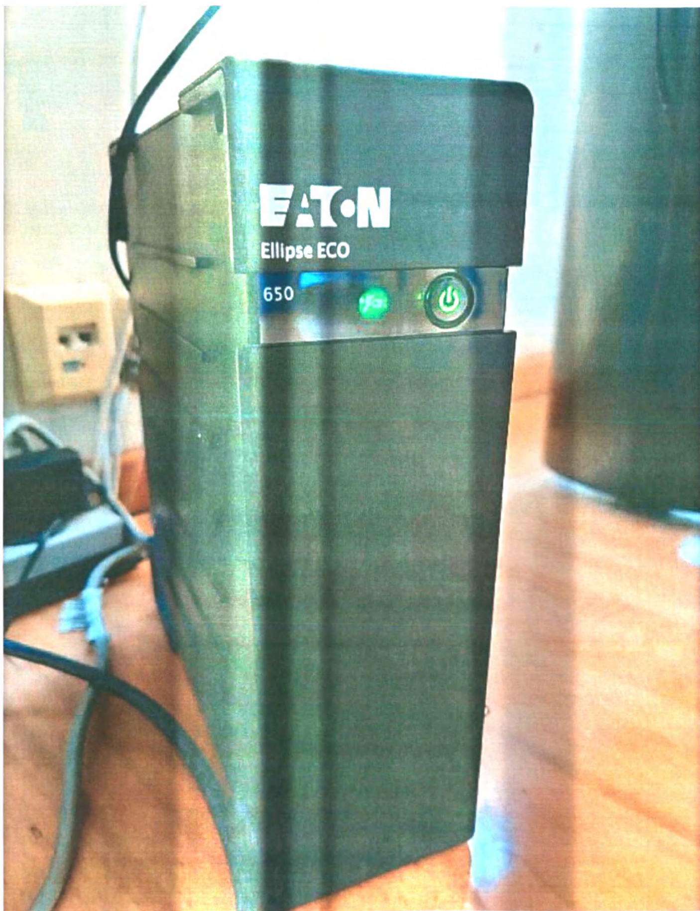
Рис 2.12. Источник бесперебойного питания, серии Eaton Ellipse ECO, производства Eaton Power Quality, Финляндия / производства Eaton Power Quality, Финляндия / производства Eaton Power Quality, Китай / производства Eaton Industries France, Франция
