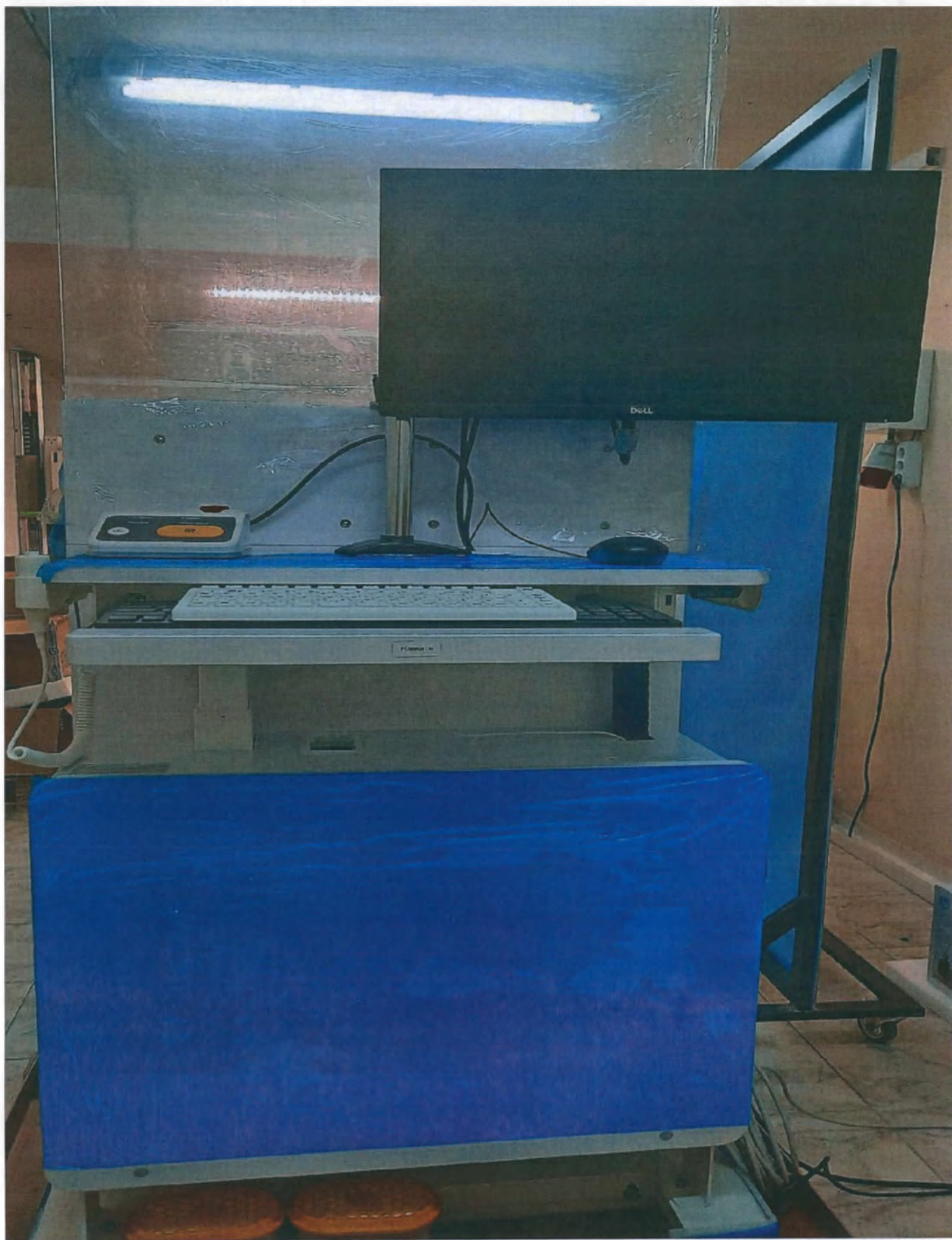
Рис 2.1. Тумба с интегрированным рентгенозащитным стеклом, модель VDMT-01A, производства «Вьюворкс Ко. Лтд», Республика Корея / модель ЛЖКМ.943129.073, производства ООО «С.П.ГЕЛПИК», Россия;
