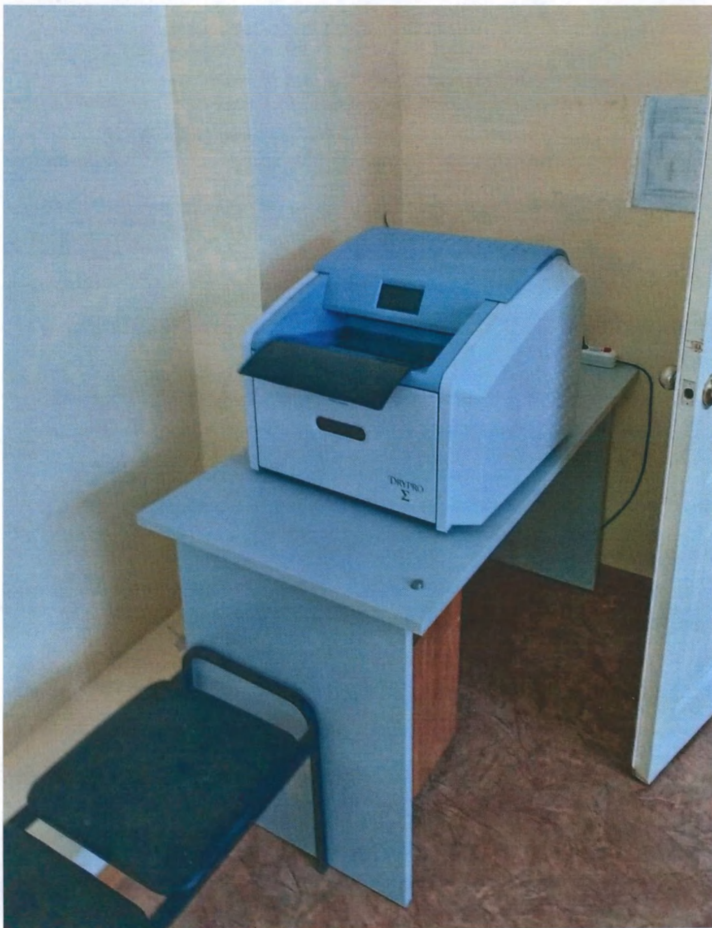
Рис 15.1. Камера лазерная мультимедийная, модель DRYPRO SIGMA с принадлежностями, РУ №ФСЗ 2012/12920
