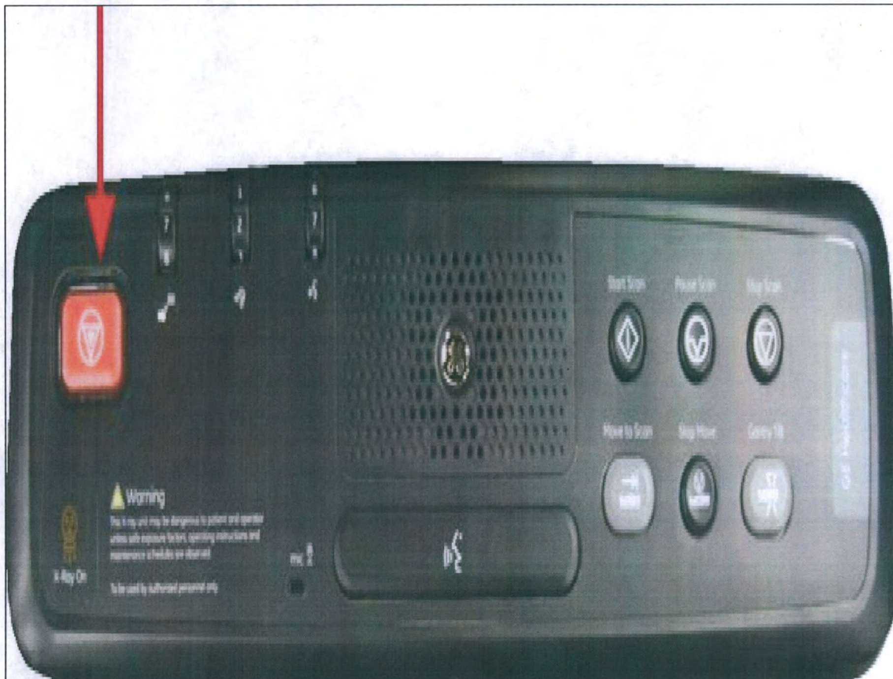
Пульт управления оператора.
