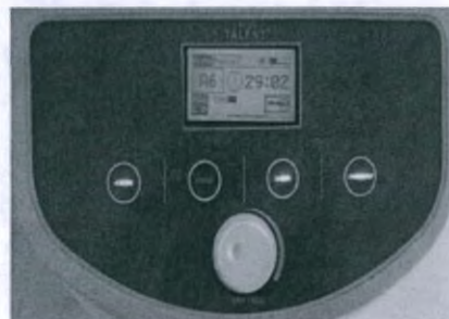
(c) Поворачивая энкодеры, установите магнитную напряженность. Оборудование инициирует операцию. Напряженность магнитного поля отображается в%, а значок преобразователя в правом нижнем углу показывает форму выходного магнитного поля.
