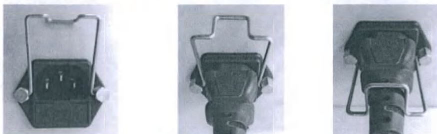
Рисунок 3. Подключение кабеля питания
