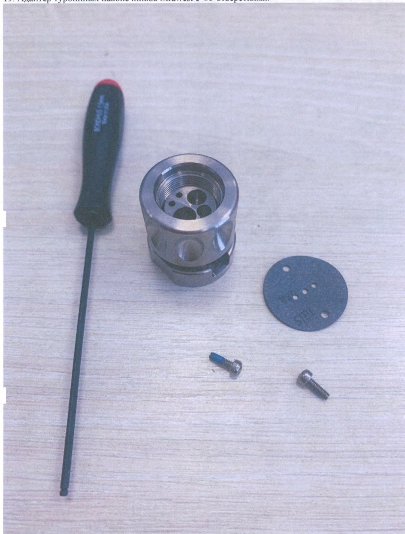
19. Адаптер турбинных наконечников Midwest с 4/5 отверстиями.
