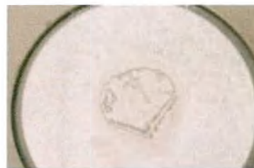
Рис. 110. Торцы оптического волокна в разъеме оптического волокна с загрязнением
