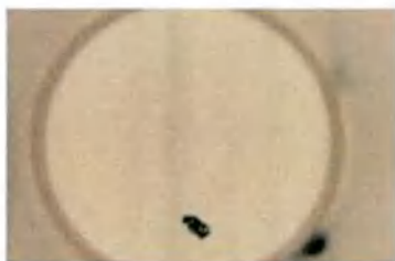
Рис. 110. Торцы оптического волокна в разъеме оптического волокна с загрязнением
