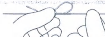
Рисунок 4: Конеч стилет-катетера и инструмент для повторного заключения в оболочку удерживаются таким образом, что прозрачный язычок находится между большим и указательным пальцами
