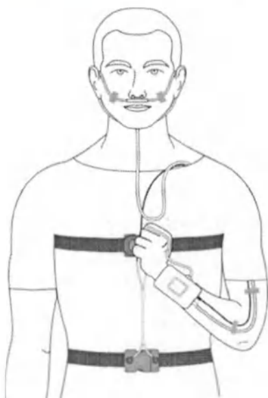
Рис. 20. Фиксация датчиков и электронного блока полиграфа на теле пациента
