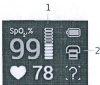
Рис. 24. Пульсоксиметрический датчик неправильно позиционирован или неисправен
