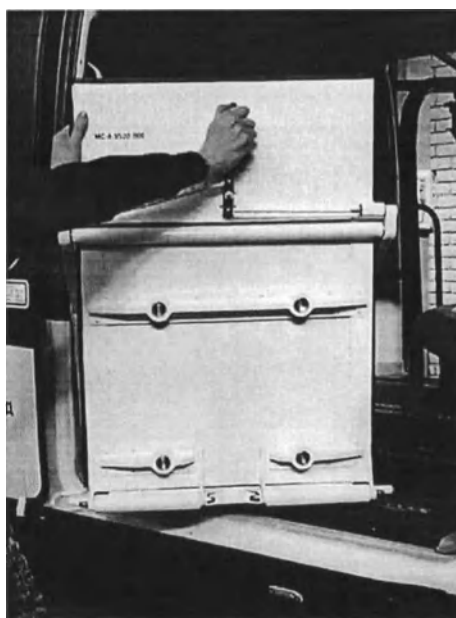
а Рисунок 2.04 – Расфиксация и пере- вод борта УП в положение погрузки
