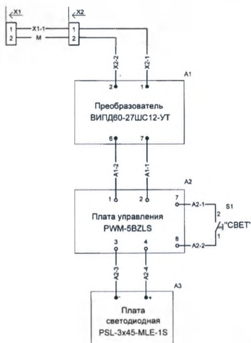
Рисунок 1.11 – Светильник. Схема электрическая принципиальная
