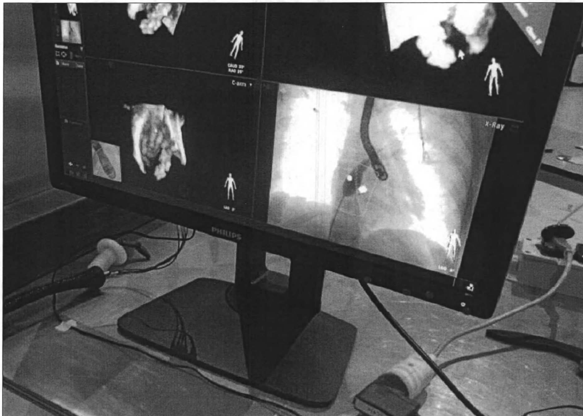
10.а. Оборудование пультовой в составе: Мониторы цветные для пультовой диагональю 24 дюйма-2шт.; Модуль просмотра, не более 3шт.; Мышь; Клавиатура; Системный блок с базовым программным обеспечением для системы Azurion версия 1.1 и выше.
