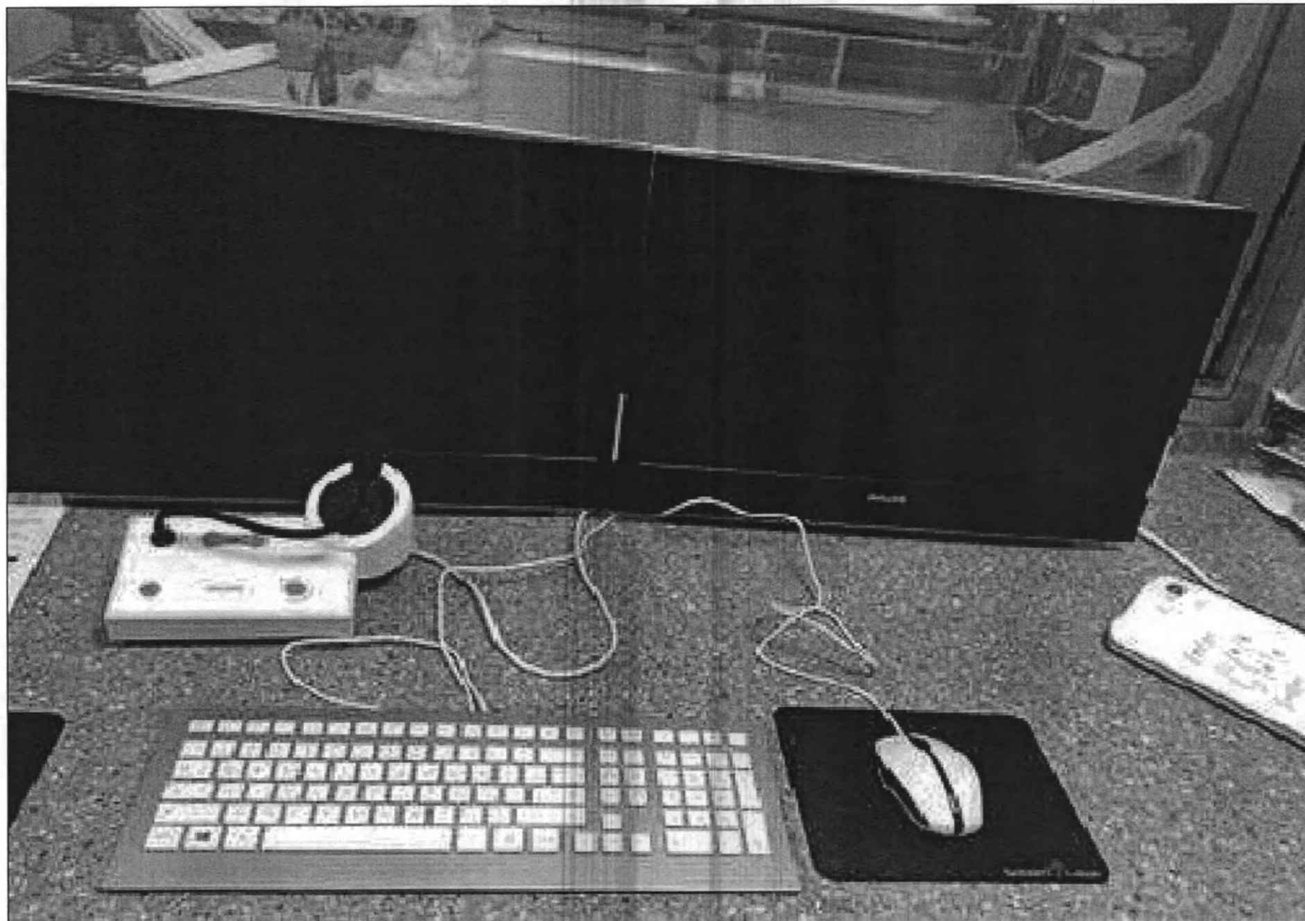
10.а. Оборудование пультной в составе: Мониторы цветные для пультной диагональю 24 дюйма; Модуль просмотра; Мышь; Клавиатура; Системный блок с базовым программным обеспечением для системы Azurion версия 1.1 и выше.
