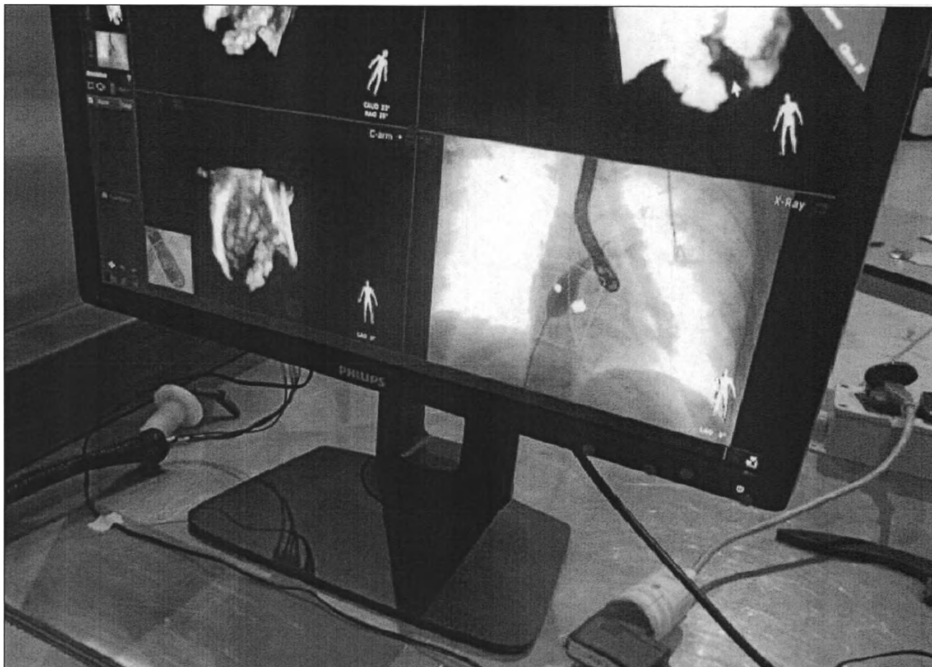
9.6. Оборудование пультной в составе: Мониторы цветные для пультной диагональю 24 дюйма; Модуль просмотра; Мышь; Клавиатура; Системный блок с базовым программным обеспечением для системы Azurion версия 1.1 и выше.
