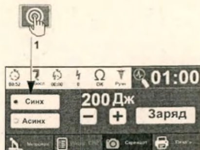
Рис. 5.6 Переключение в режим синхронизированной дефибрилляции
