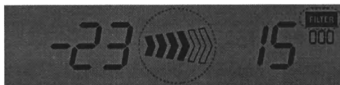
Рисунок 5.14 – Вид ЖК-экрана, при уведомлении о выработке ресурса фильтров
