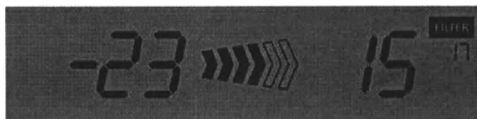
Рисунок 5.13 – Вид ЖК-экрана, при уведомлении о количестве дней до сервисного обслуживания
