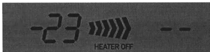
Рисунок 5.8 – Вид ЖК-дисплея при выключенном нагревателе системы климат-контроля
