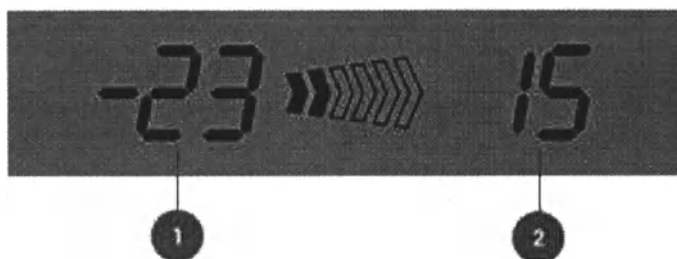
Рисунок 5.9 – Вид ЖК-дисплея при выключенном нагревателе системы климат-контроля: 1 – Температура воздуха, поступающего в прибор; 2 – Температура воздуха, подаваемого в помещение.
