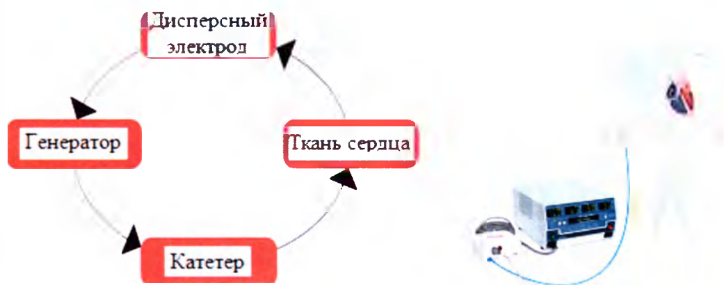
Рис. 8. Высокочастотный электрический контур
