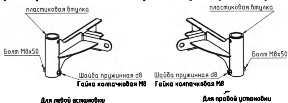
Рисунок 6 – Сборка кронштейна рамы для подтягивания
