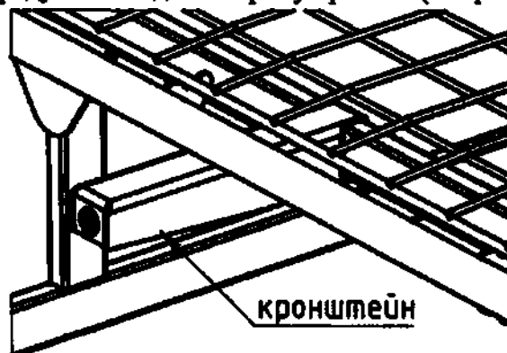
Рисунок 11 – Установка кронштейна бокового ограждения на раме кровати
