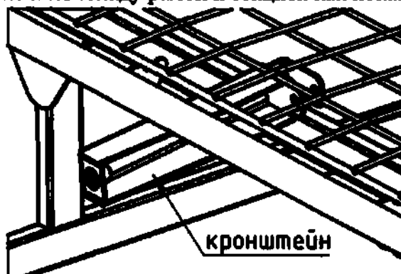
Рисунок 11 – Установка кронштейна бокового ограждения на раме кровати
