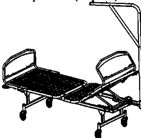
Рисунок 8 – Установка рамы для подтягивания
