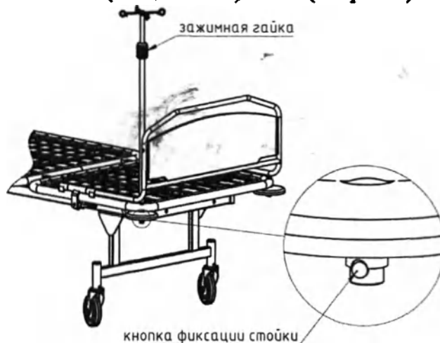
Рисунок 3 – Установка стойки капельницы
