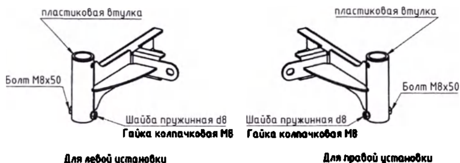
Рисунок 6 – Сборка кронштейна рамы для подтягивания
