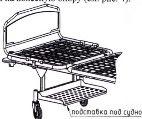
Рисунок 4 – Установка подставки под судно
