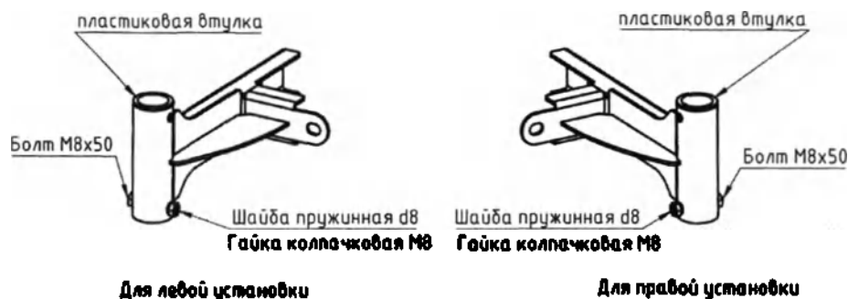
Рисунок 6 – Сборка кронштейна рамы для подтягивания
