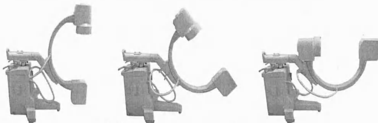
[Рис3.1] Орбитальное движение С-дуги
