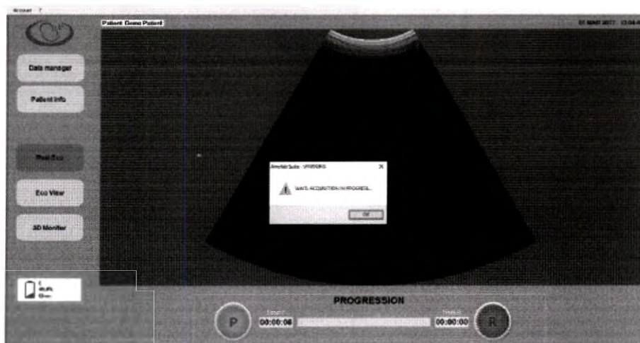
Рисунок 34. Окно оповещения «Подождите: выполняется сбор данных» («Wait: Acquisition in progress») появляется при нажатии на кнопки панели управления во время обработки полученных данных.
