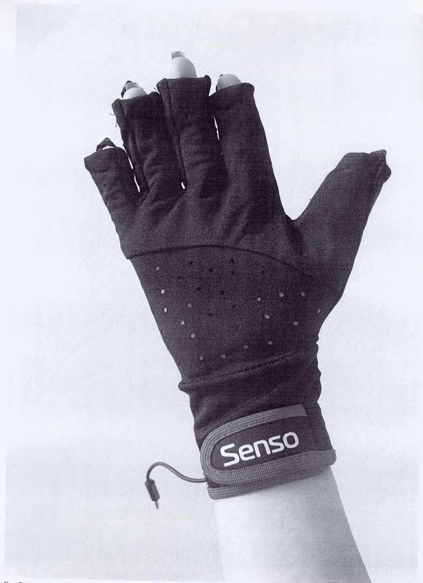
Реабилитационный комплекс для восстановления мелкой моторики руки «ПЕРЧАТКА-ТРЕНАЖЕР «SENSO REHAB».
