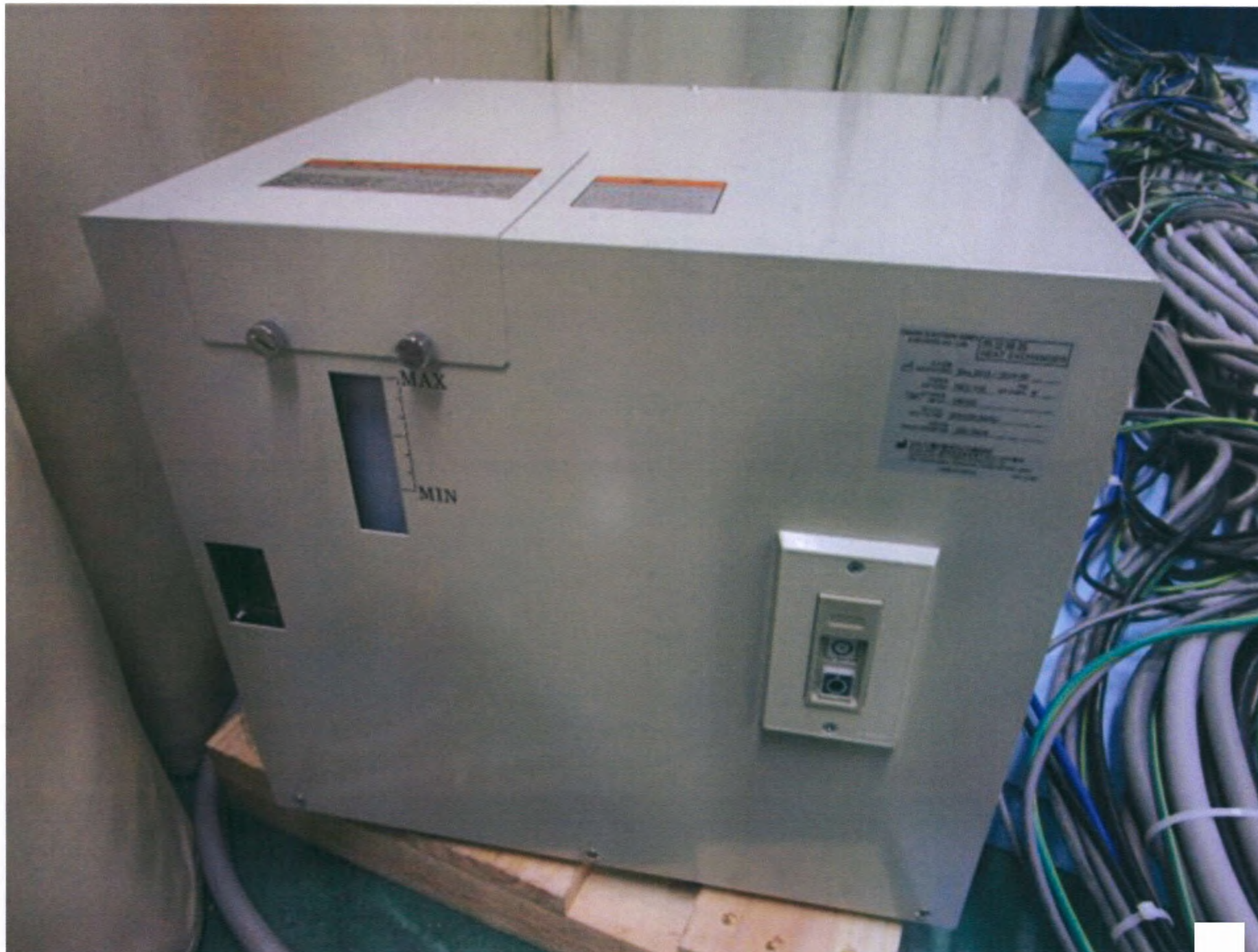
7. Теплообменник с водяным охлаждением (производитель Canon electron tubes & devices, Япония).
