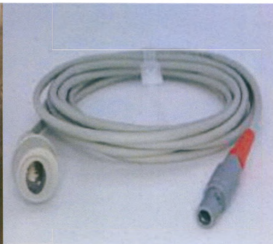
Красный коннектор кабеля-удлинителя ИВР к разъему с надписью ИВР на усилителе QMAPP.
