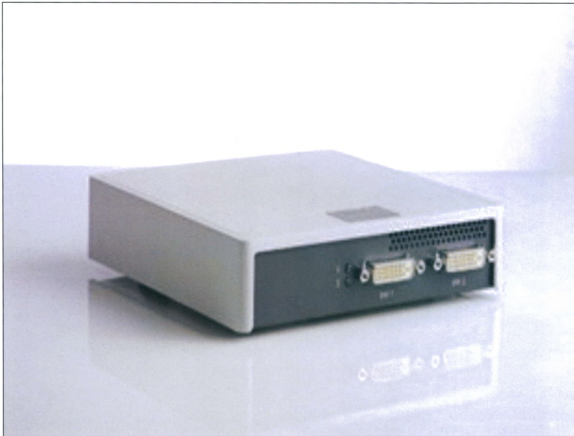
82. Цифровое кодирующее устройство для добавления двух входных каналов DVI.
