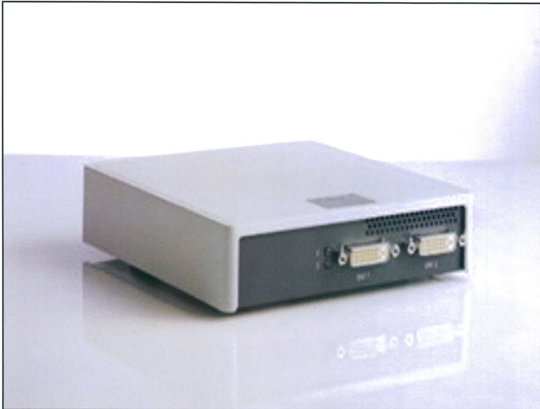
77. Цифровое кодирующее устройство для добавления двух входных каналов DVI.
