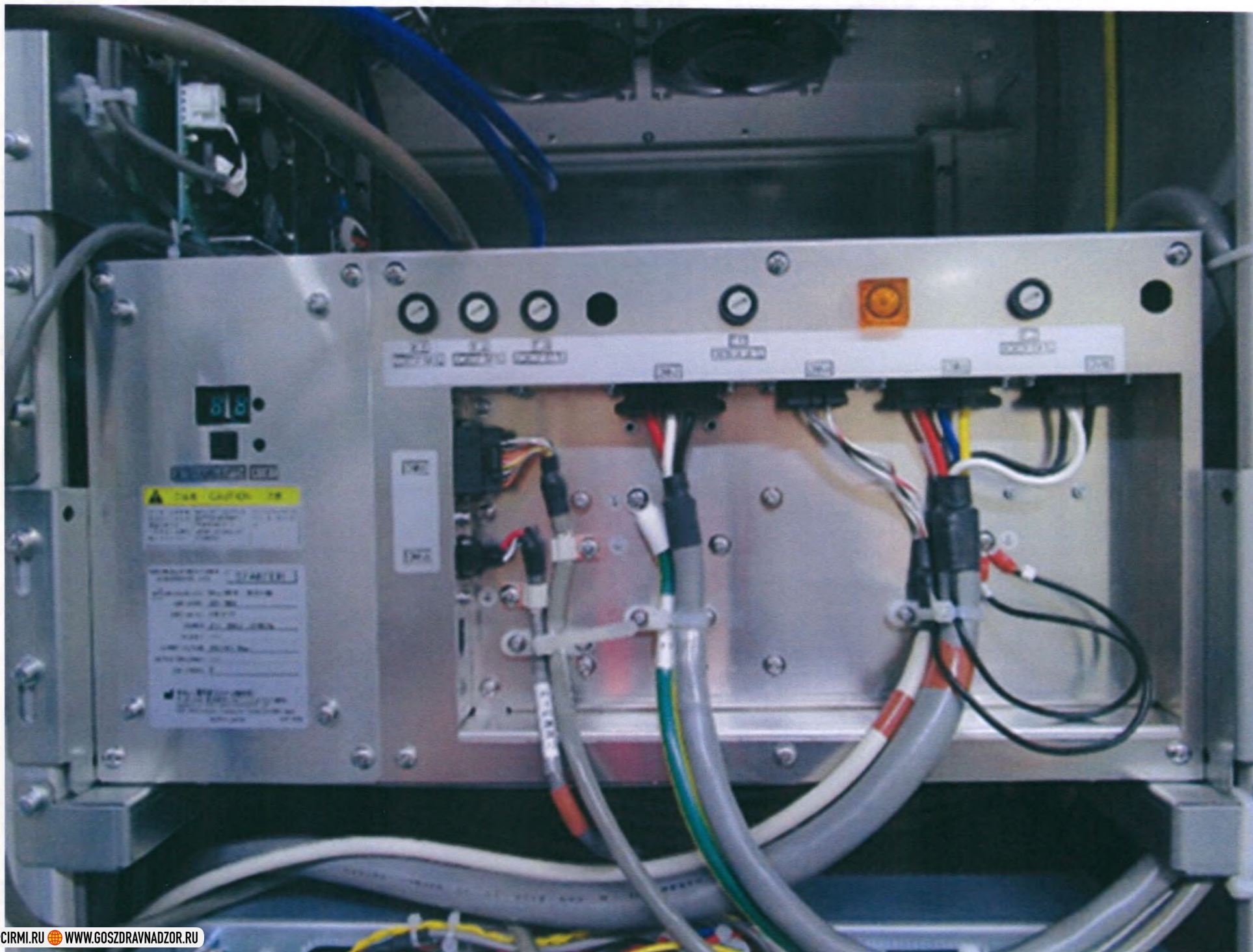
5. Скоростное пусковое устройство с вращающимся анодом (производитель Canon electron tubes & devices, Япония) - 2 шт.
