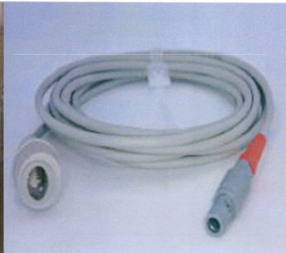
Красный коннектор кабеля-удлинителя IBP к разъему с надписью IBP на усилителе QMAPP.
