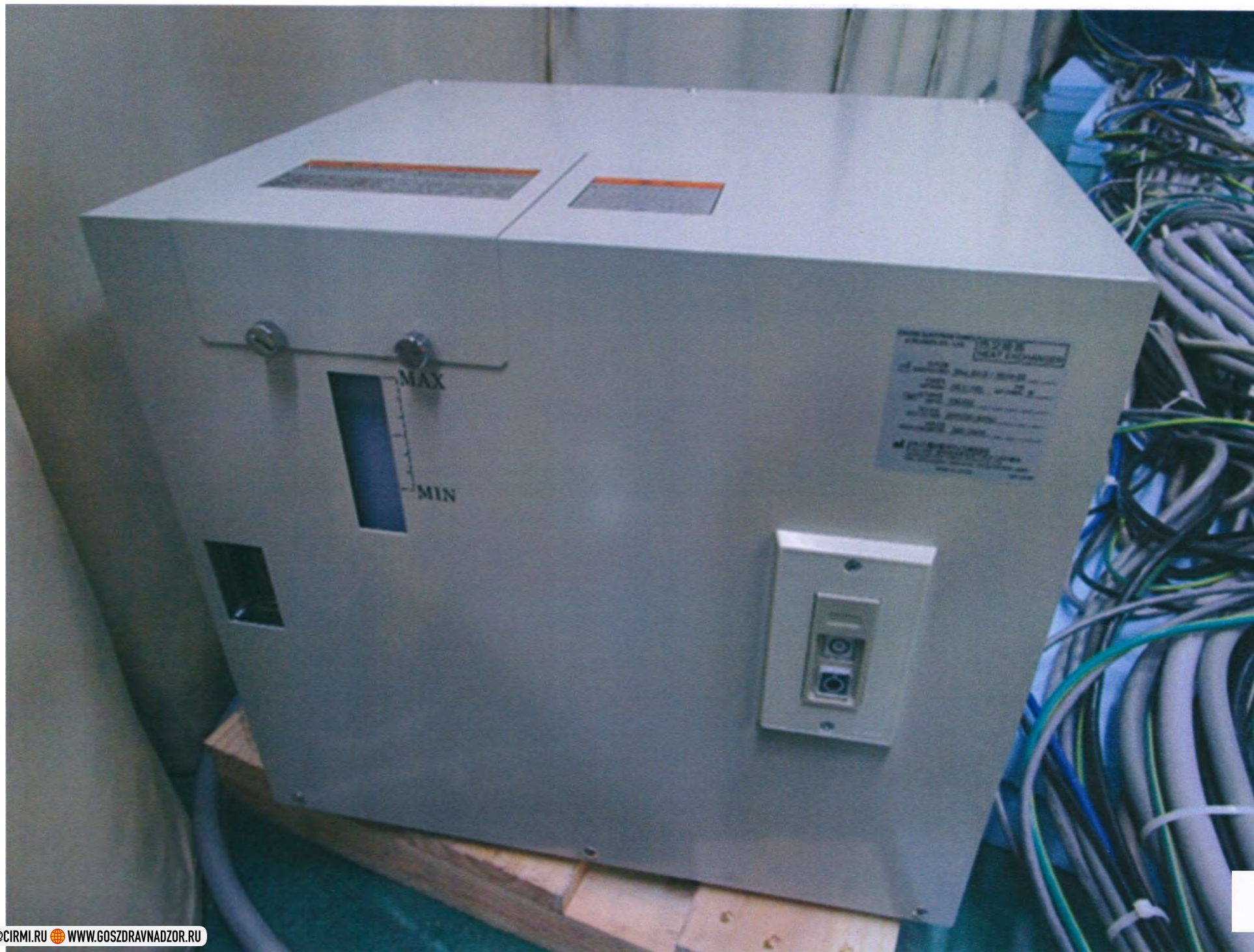
7. Теплообменник с водяным охлаждением (производитель Canon electron tubes & devices, Япония) - 2 шт.
