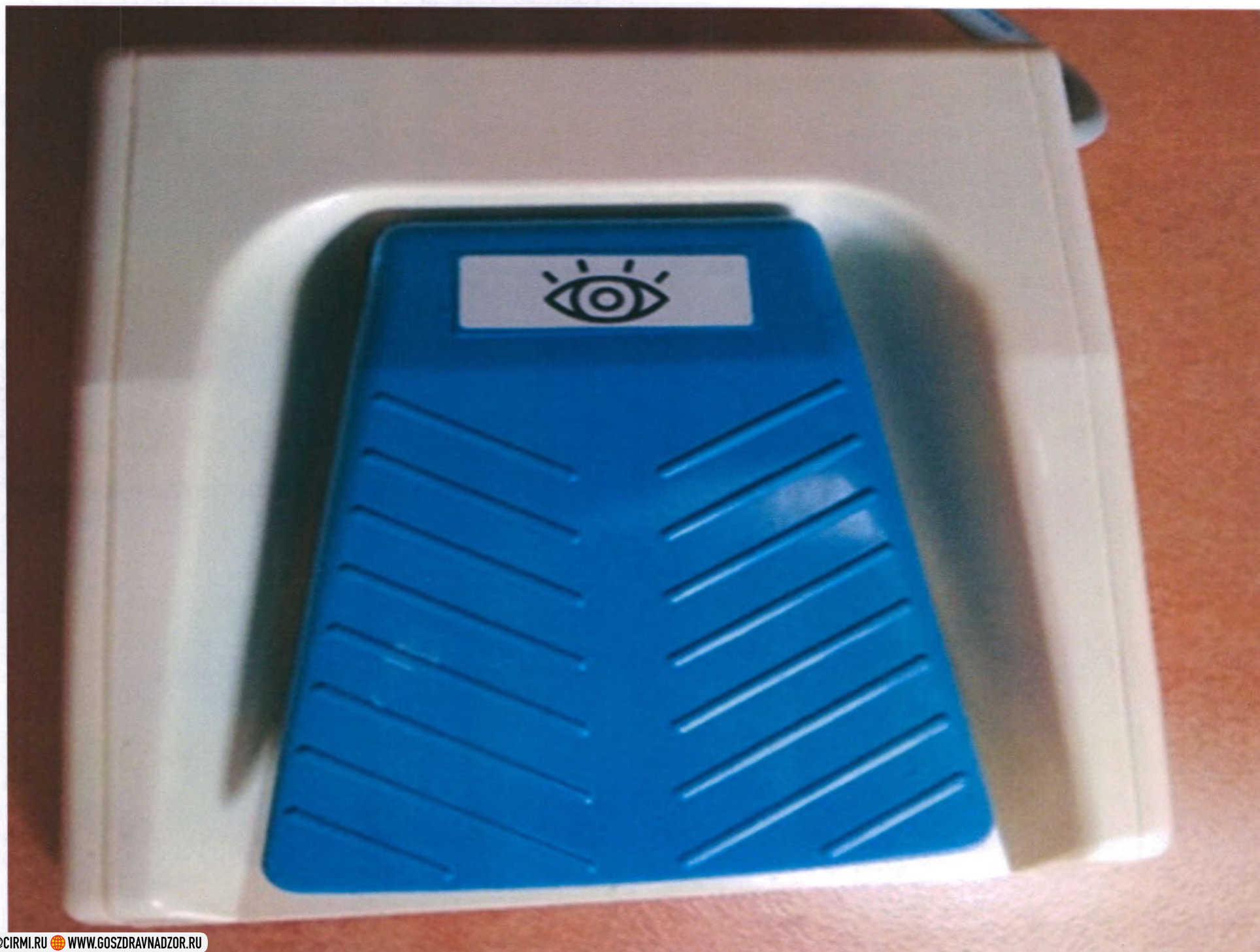
16. Ножной переключатель для рентгенографии в кабинете управления.
