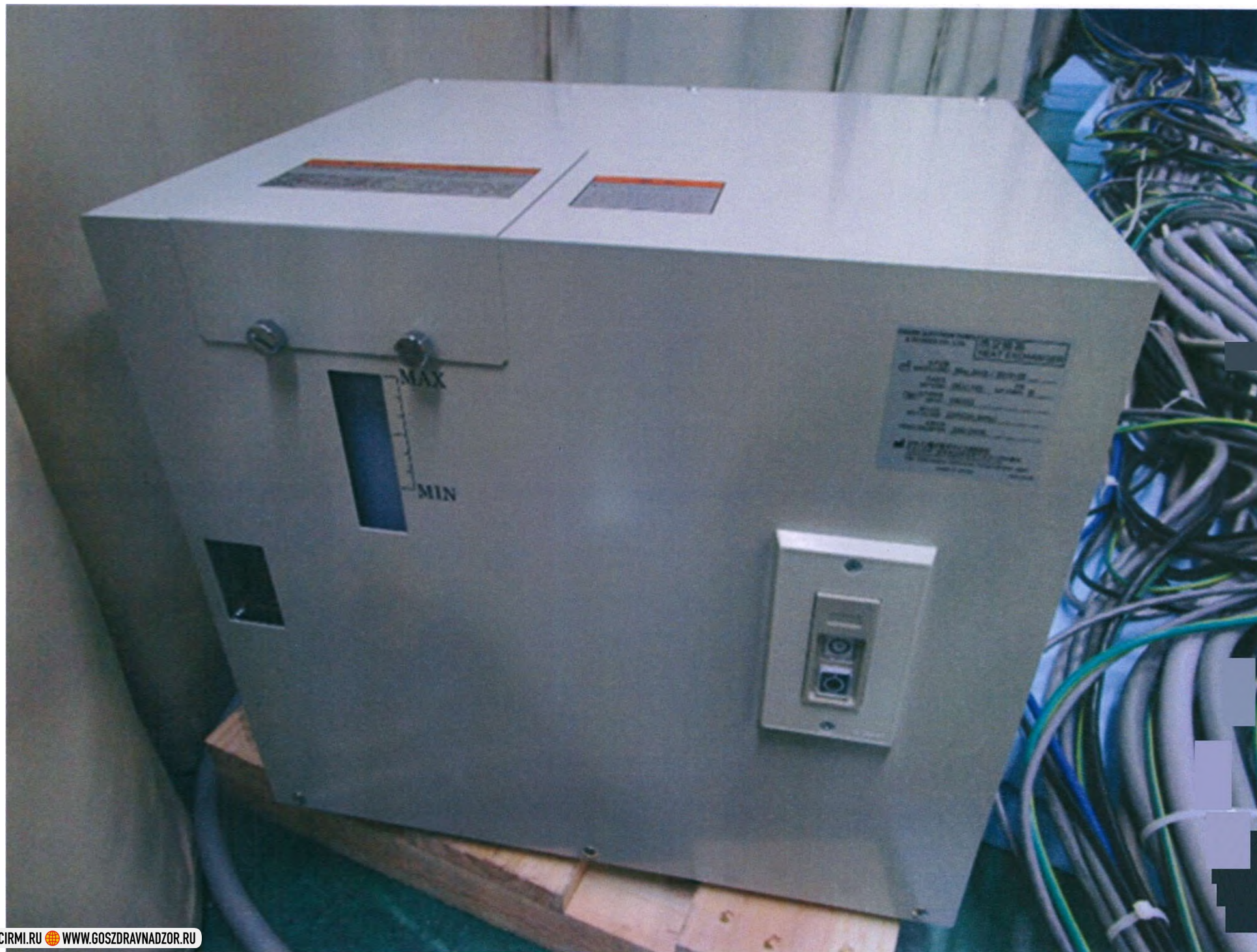
6. Теплообменник с водяным охлаждением (производитель Canon electron tubes & devices, Япония).
