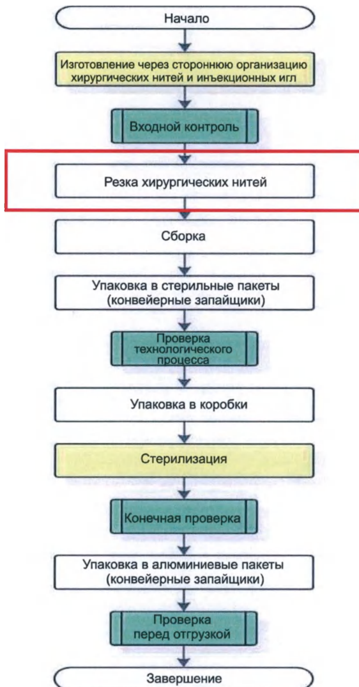
Рис.14. Схема производственного процесса
