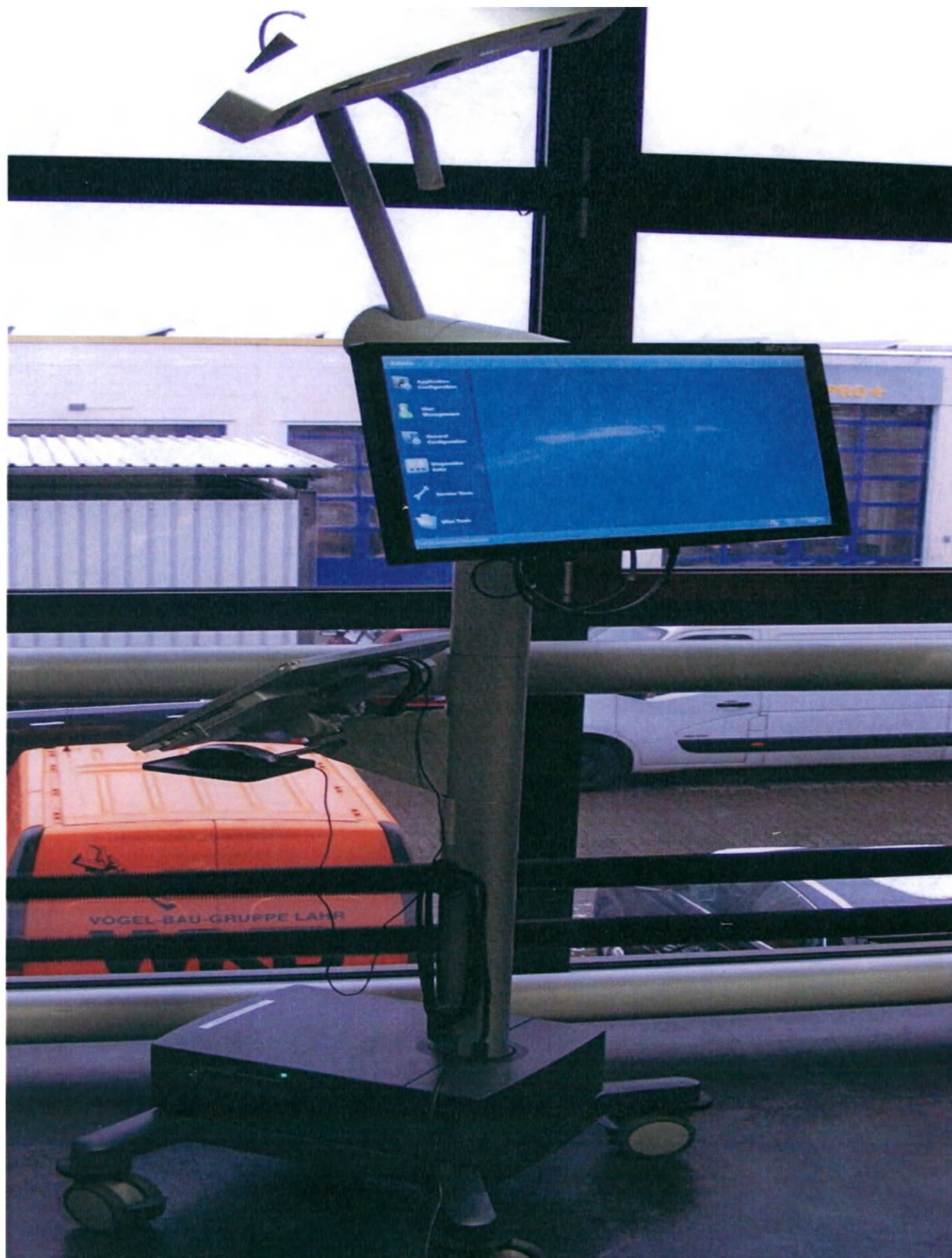
I. Стойка навигационная NAV3, в составе: системный блок; планшет ввода-вывода; монитор; навигационная камера FP6000; интерфейсный блок; основание с колесами; кронштейн камеры; шарнир камеры; стойка; рукоятка камеры; держатель для кабеля; подставка для мыши.
