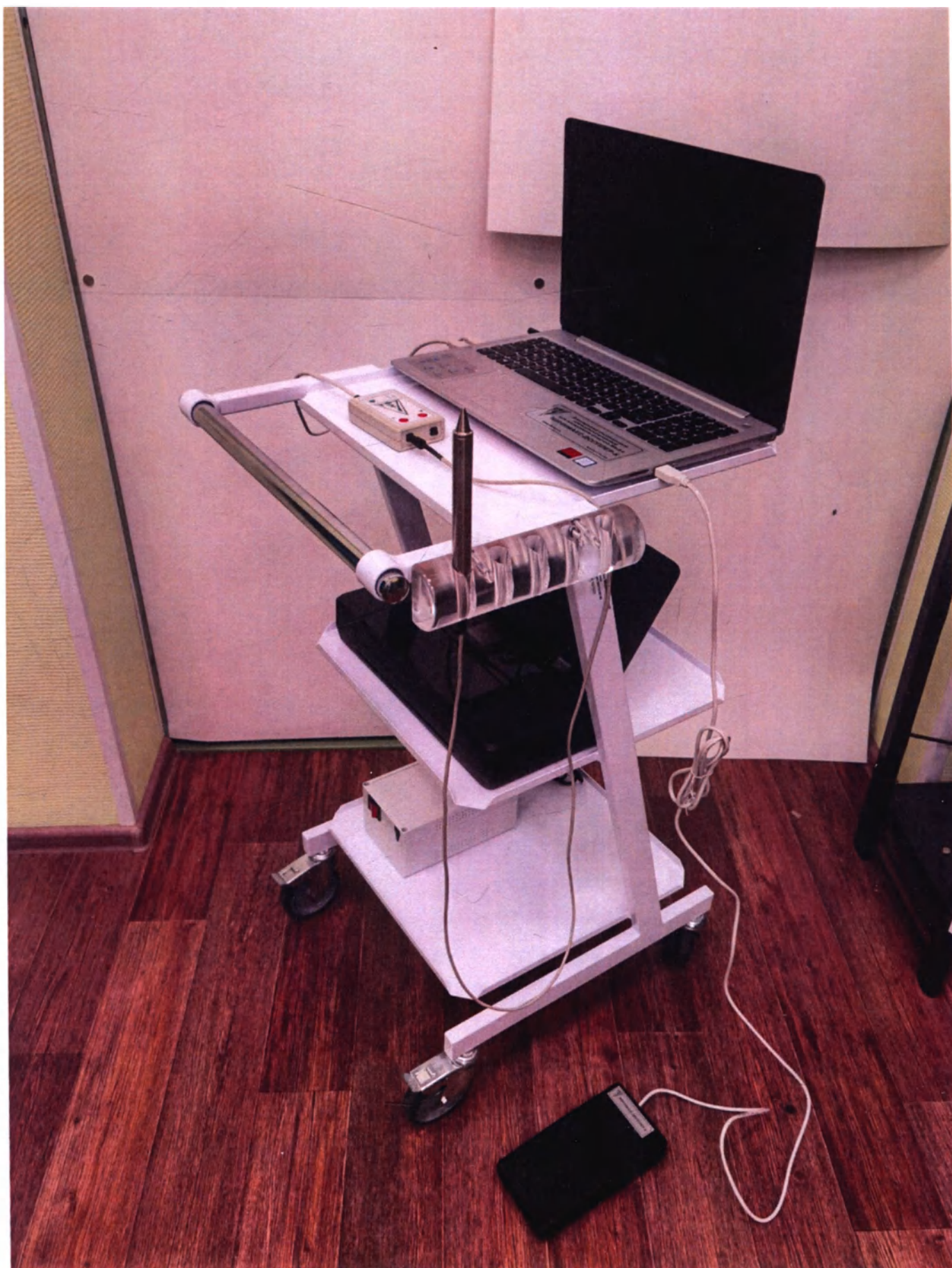
Рисунок 14 – Допплерограф ультразвуковой компьютеризированный для исследования кровотока ММ-Д-К «Минимакс-доплер-К», прибор исполнение 02
