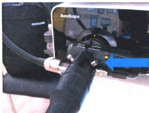
Разъем стандарта Люер дополнительного канала для ирригации на эндоскопе
