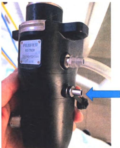
Разъем (3) стандарта Люер дополнительного канала для ирригации на эндоскопе
