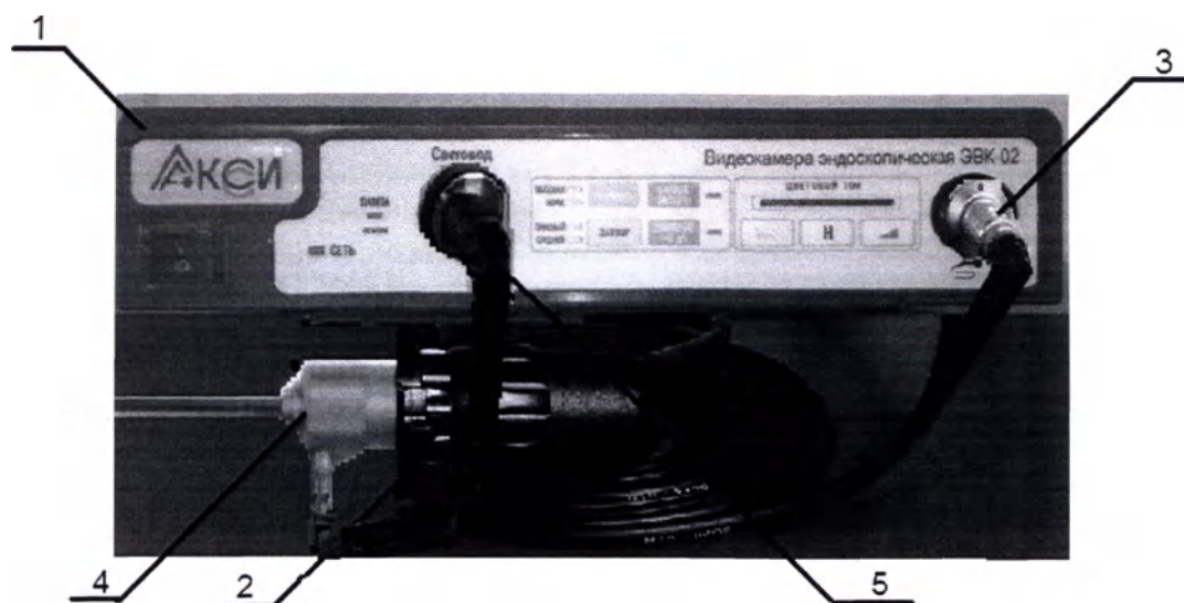
Рис.2 Общий вид видеокомплекса с соединенными между собой видеокамерой, камерной головкой и трубкой оптической.
