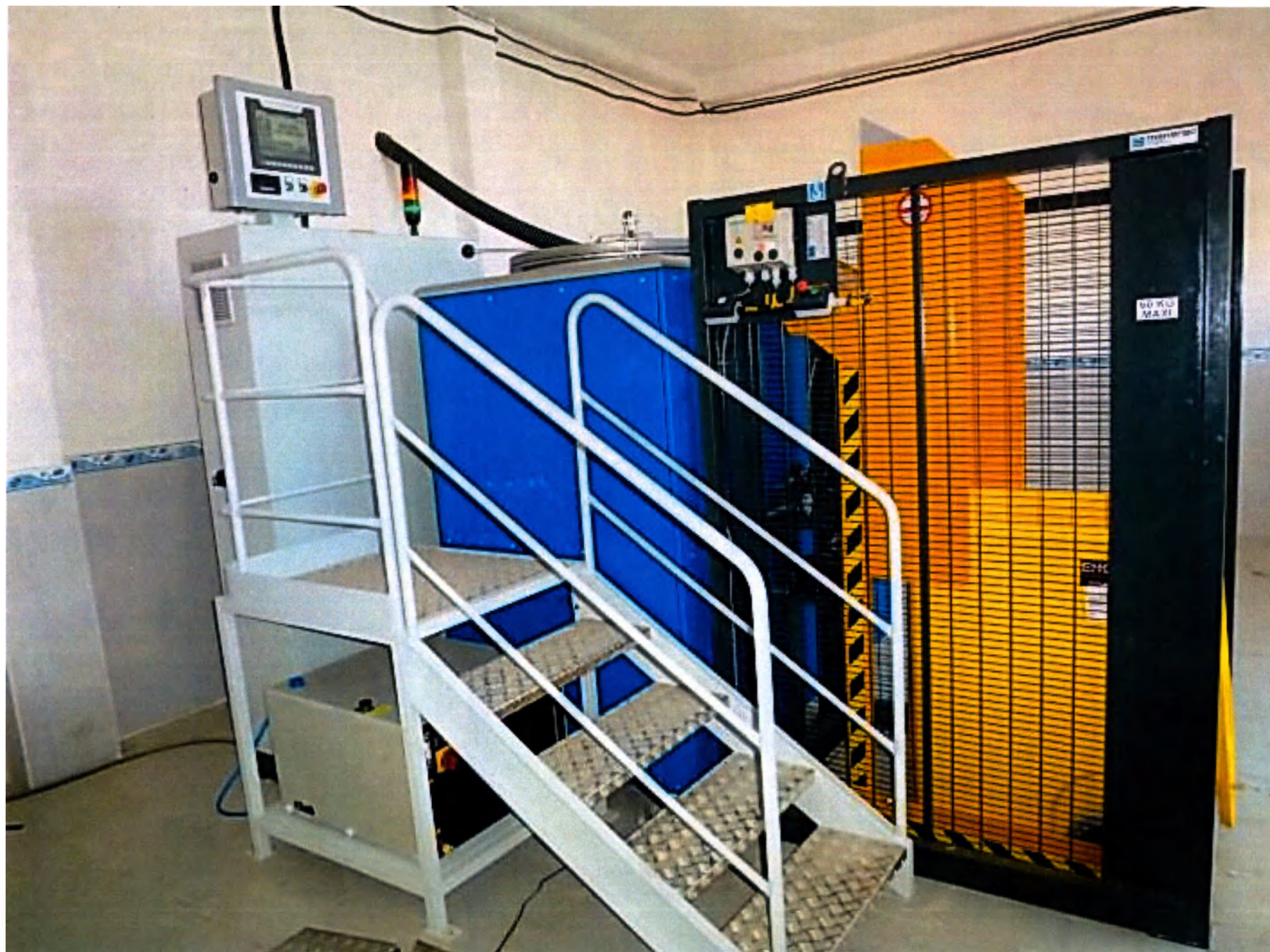
Установка в исполнении STERILWAVE 440 (с опцией – опрокидыватель контейнера)
