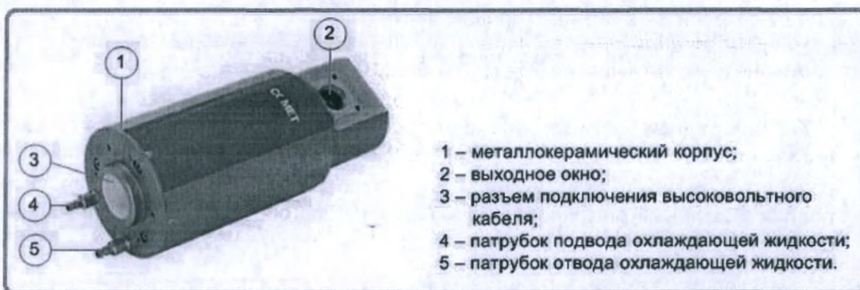
Рисунок 3.5 – Внешний вид рентгеновской трубки
