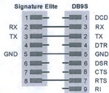
Подключение анализатора к любому персональному компьютеру с разъемом DB9P
