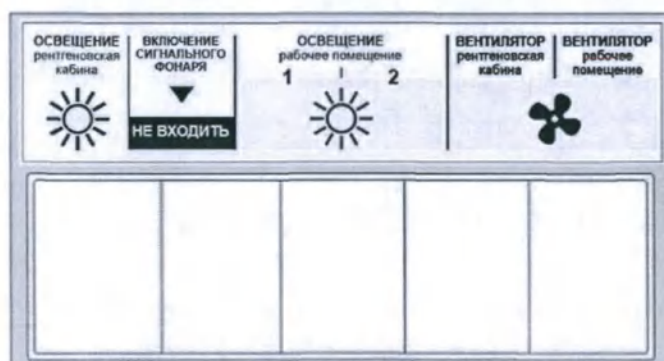
Рисунок 3.2 – Выключатели в комнате управления
