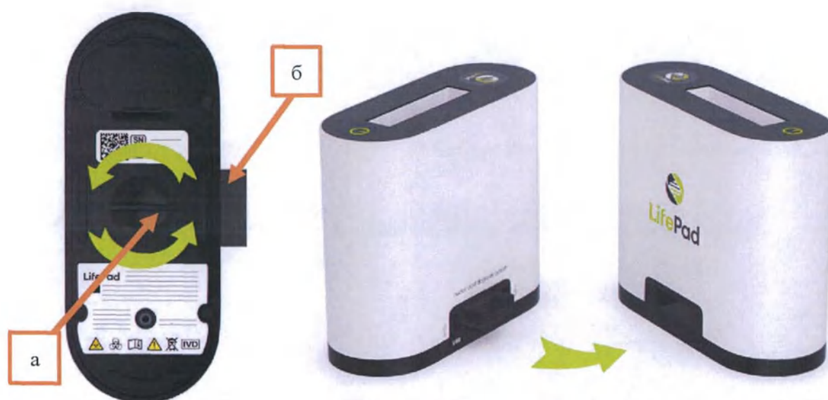
Рисунок 9. Выдвижной разъем (слева). Вариант подключения кластерного режима подключения двух приборов через разъем (справа)
