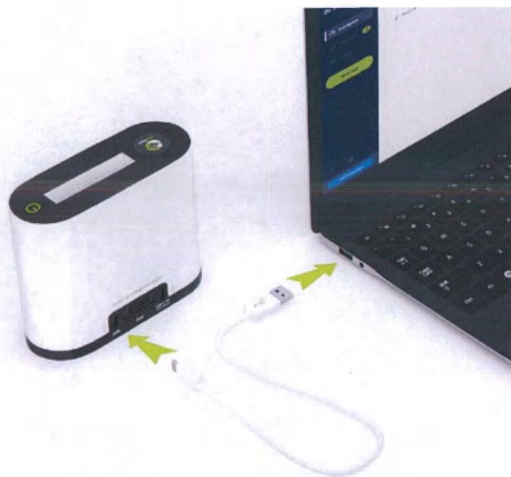
Рисунок 24. Схема подключения Анализатора к портативному компьютеру
